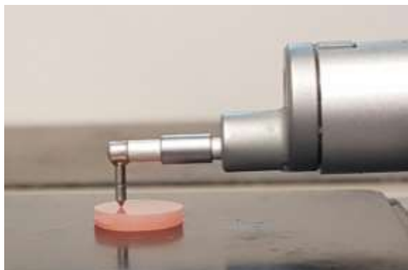
Leitura das amostras de RAAT, posicionadas no rugosímetro
