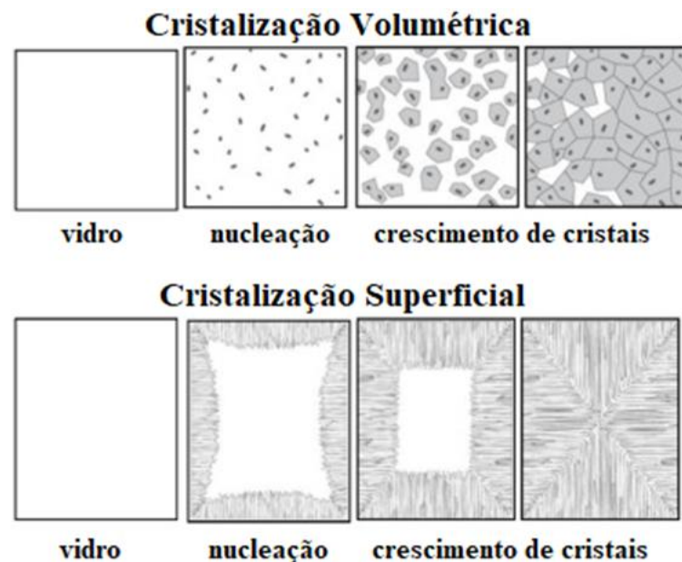
Figura 9 - Processo de cristalização do vidro precursor para obter materiais vitrocerâmicos
