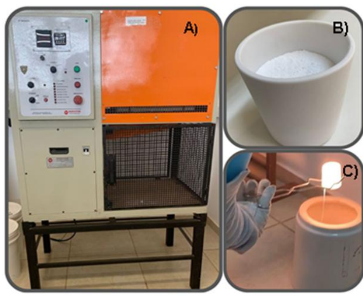
Figura 12 - A) Forno de fusão, B) amostra no cadinho de alumina, C) amostra sendo vertida
