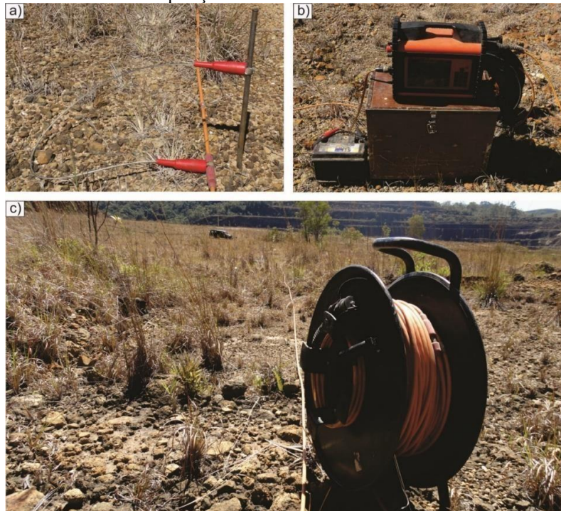
Figura 15: Aquisição de dados geofísicos por meio de técnica de tomografia elétrica. a) Detalhe do sistema de aterramento elétrico para aquisição de dados. b) Resistivímetro tomográfico ABEM Terrameter LS em operação; c) Linha de tomografia elétrica durante aquisição de dados.
