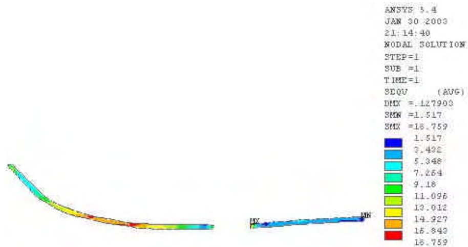
Figura 43 – Mapa de tensão de von Mises no osso cortical distalmente ao dente suporte no modelo C (com PPR e implante de 3,75 x 7,00 mm)
