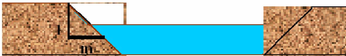
Figura 1 – Canal de adução com inclinação “m”
