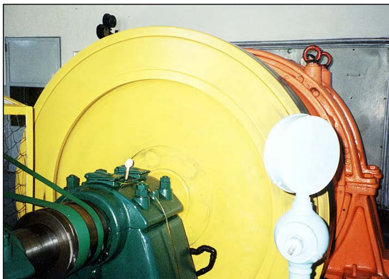
Figura 10 – Foto com destaque para o volante de inércia
