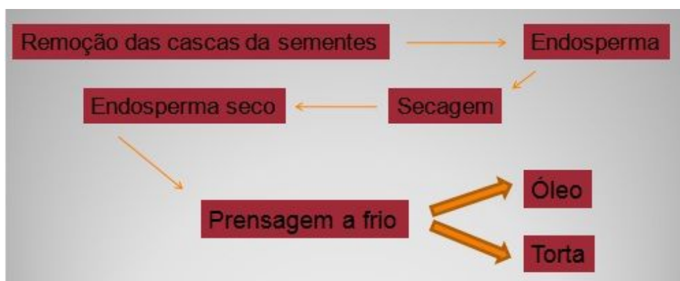
FIGURA 2 – Esquema de prensagem para produção da torta
