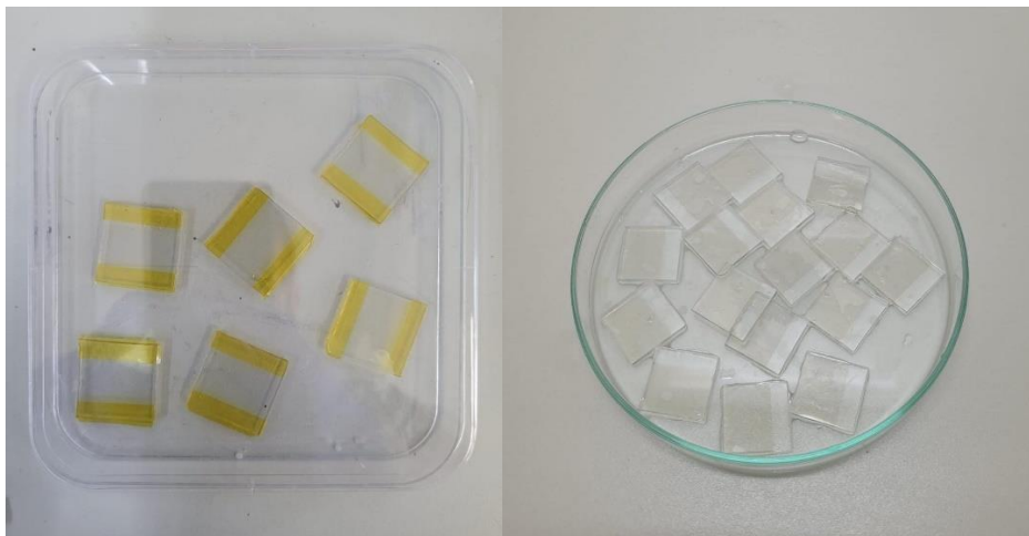
Figura 35: Substratos de óxido de estanho dopado com flúor (FTO) protegido antes de ser corroído por Zn e HCl (esquerda) e após o procedimento de corrosão e lavagem (direita).
