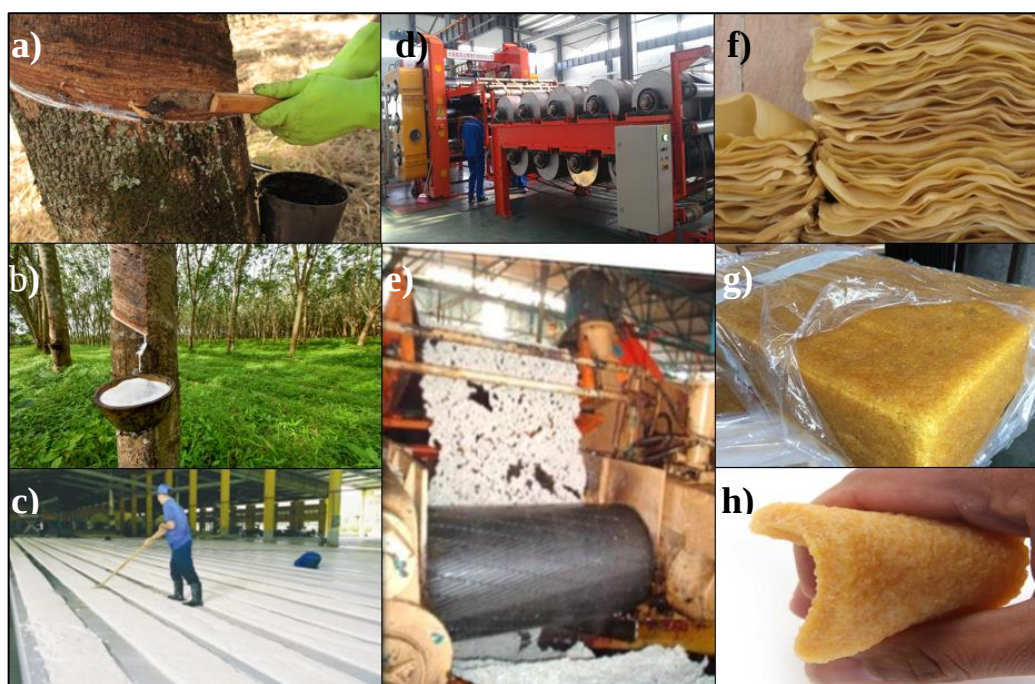
Figura 3. Etapas do processo de obtenção da borracha natural tipo crepe claro brasileiro. a) Sangria. b) Coleta do látex. c) Formação das mantas. d) Processo de calandragem e) Processo de crepagem. f) Mantas secas. g) Fardo da BN após pesagem e prensagem. h) Detalhe do crepe claro, textura e flexibilidade.
