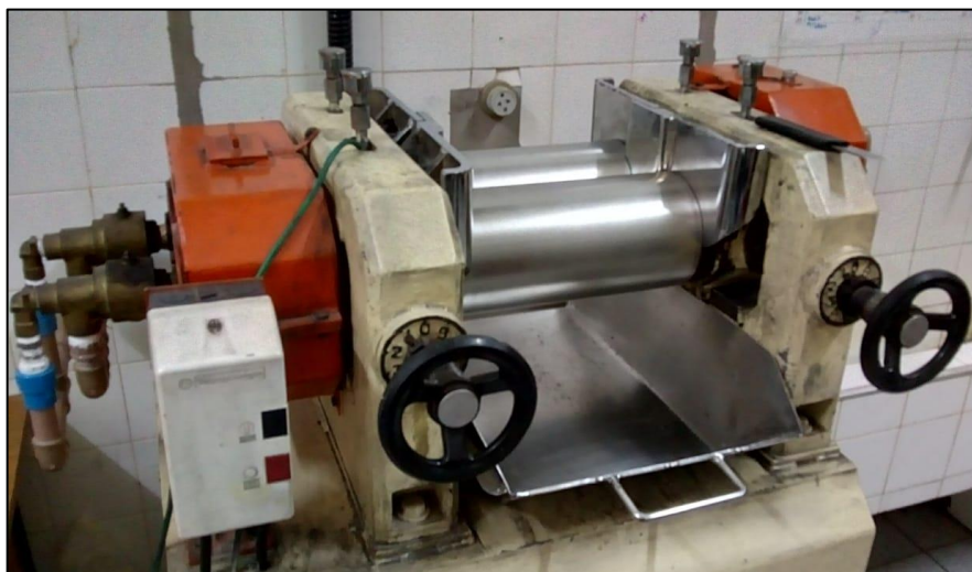
Figura 26. Misturador aberto de cilindros – Makintec, mod. 379M.
