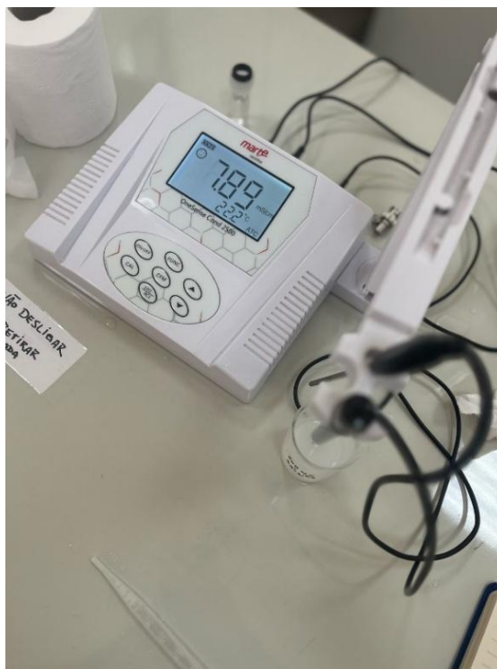
Figura 6. Análise da condutividade elétrica do KOH residual para quantificação da evolução de \text{CO}_2
