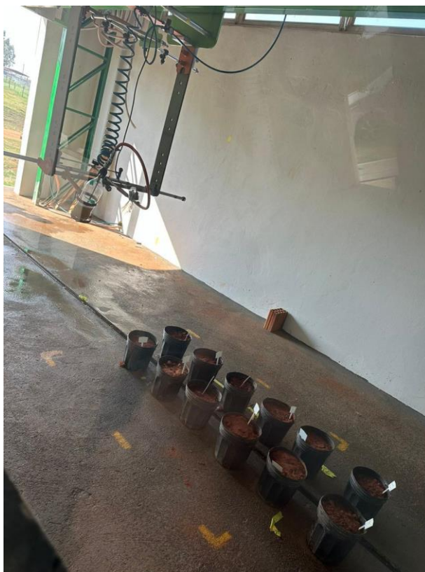
Figura 3: Pulverização automática do tebuthiuron e thiamethoxam nos vasos em ambiente fechado
