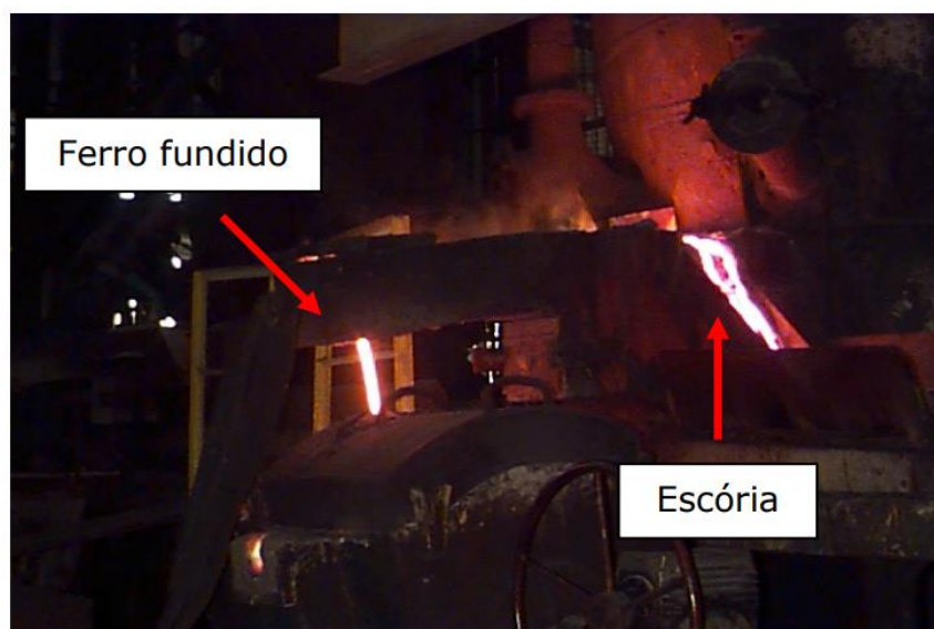
Figura 7: Escória sendo vertida em forno cubilô.
