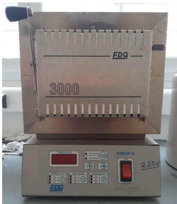
Figura 13: Mufla EDG 3000 utilizada para sinterização dos corpos de prova
