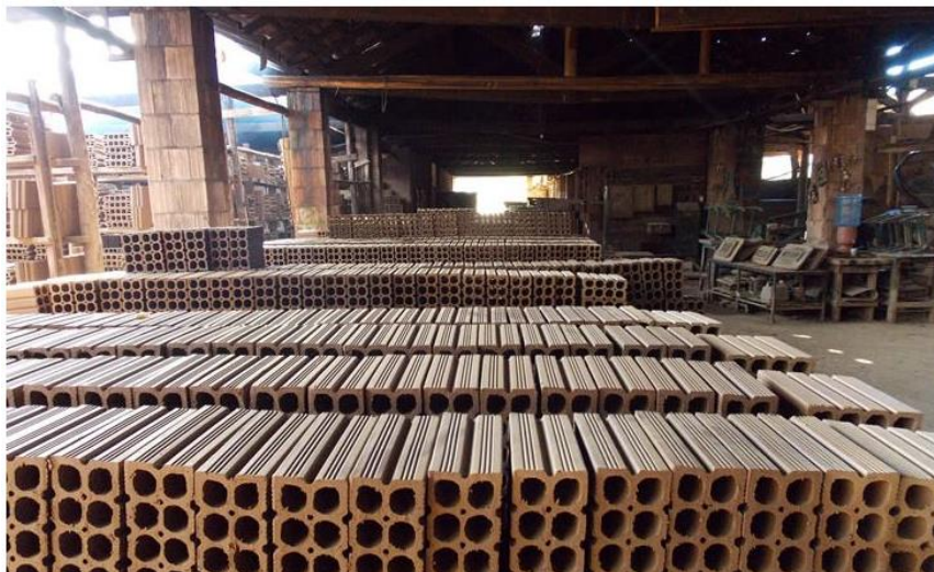
Figura 1: Blocos de vedação de 8 furos.
