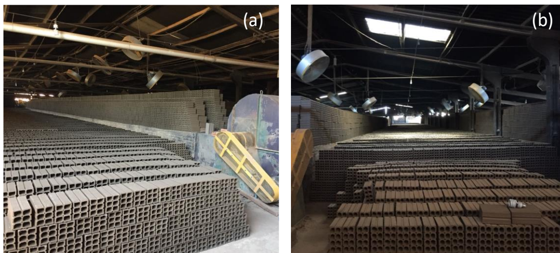
Figura 8: Blocos estruturais em processo de secagem no pátio da Indústria (Cerâmica Santa Marta): (a) 6 furos, (b) 8 furos
