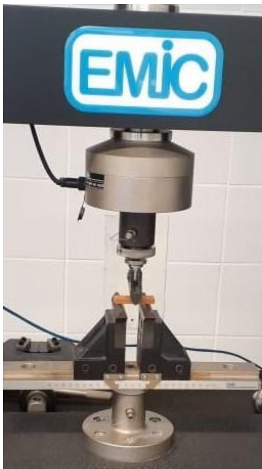
Figura 19: Equipamento de Módulo de Ruptura a Flexão de três pontos.
