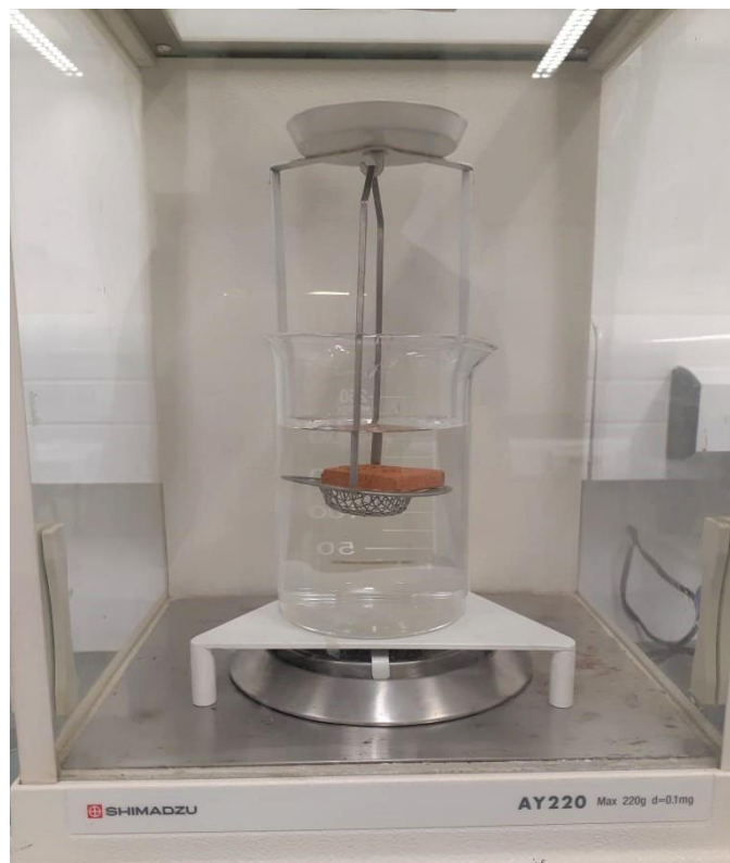
Figura 15: Esquema de funcionamento da balança hidrostática.
