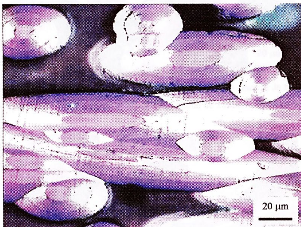
Figura 4.33 - Fotomicrografia da região da superfície da seção transversal do substrato de fibras de carbono impregnado por 48 horas com os gases na proporção de 8:1, para um fluxo total de 2 L/min.
