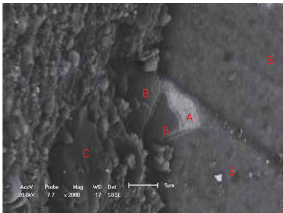
Figura 23 - Imagens em MEV em modo BSE de uma fratura tipo mista de amostra do GbMt em 2000x mostrando as diferentes fases presentes em região onde houve fratura parcial do filme: A- cerâmica à base de Y-TZP; B- filme; C- cimento resinoso.
