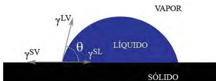
Figura 2 - Representação esquemática do ângulo de contato e das energias atuantes entre as interfaces (Oliveira Júnior, 2009).
