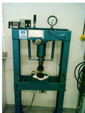
Figura 9: prensa utilizada para fabricação dos filmes de PVDF/látex, a qual dispõe de um controlador de temperatura
