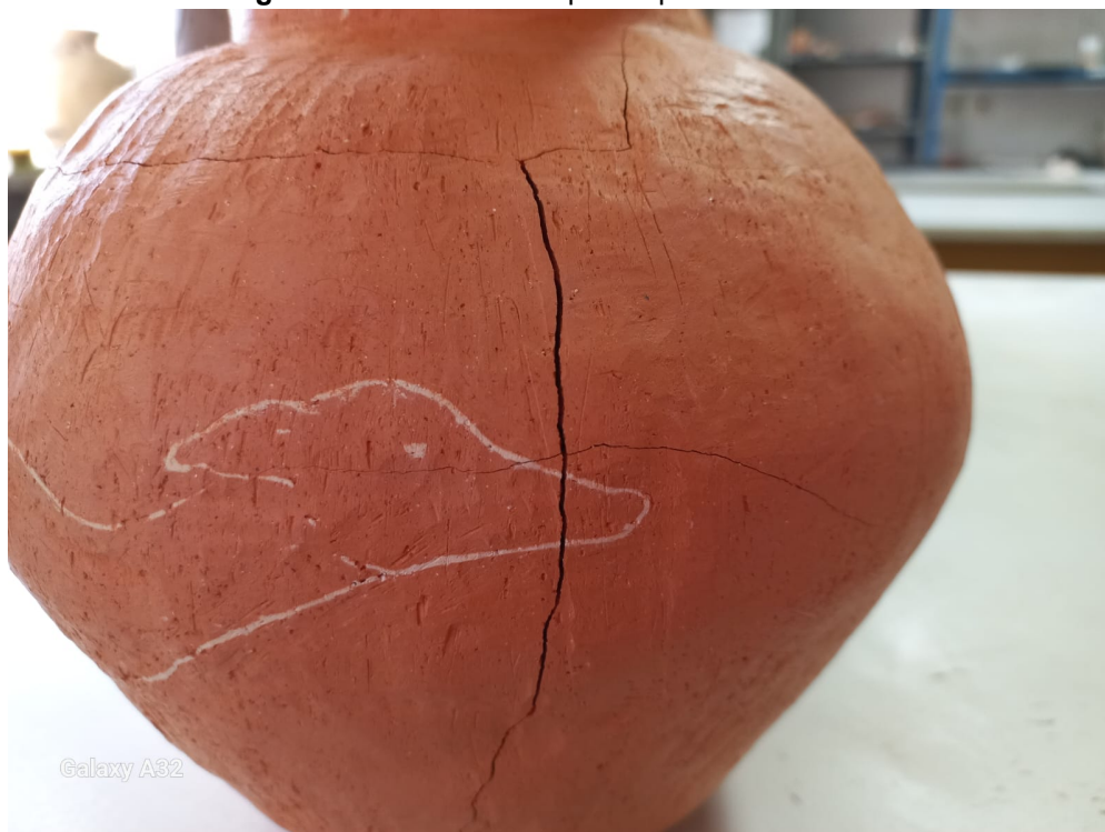
Figura 8: Vaso rachado após a queima de biscoito.
