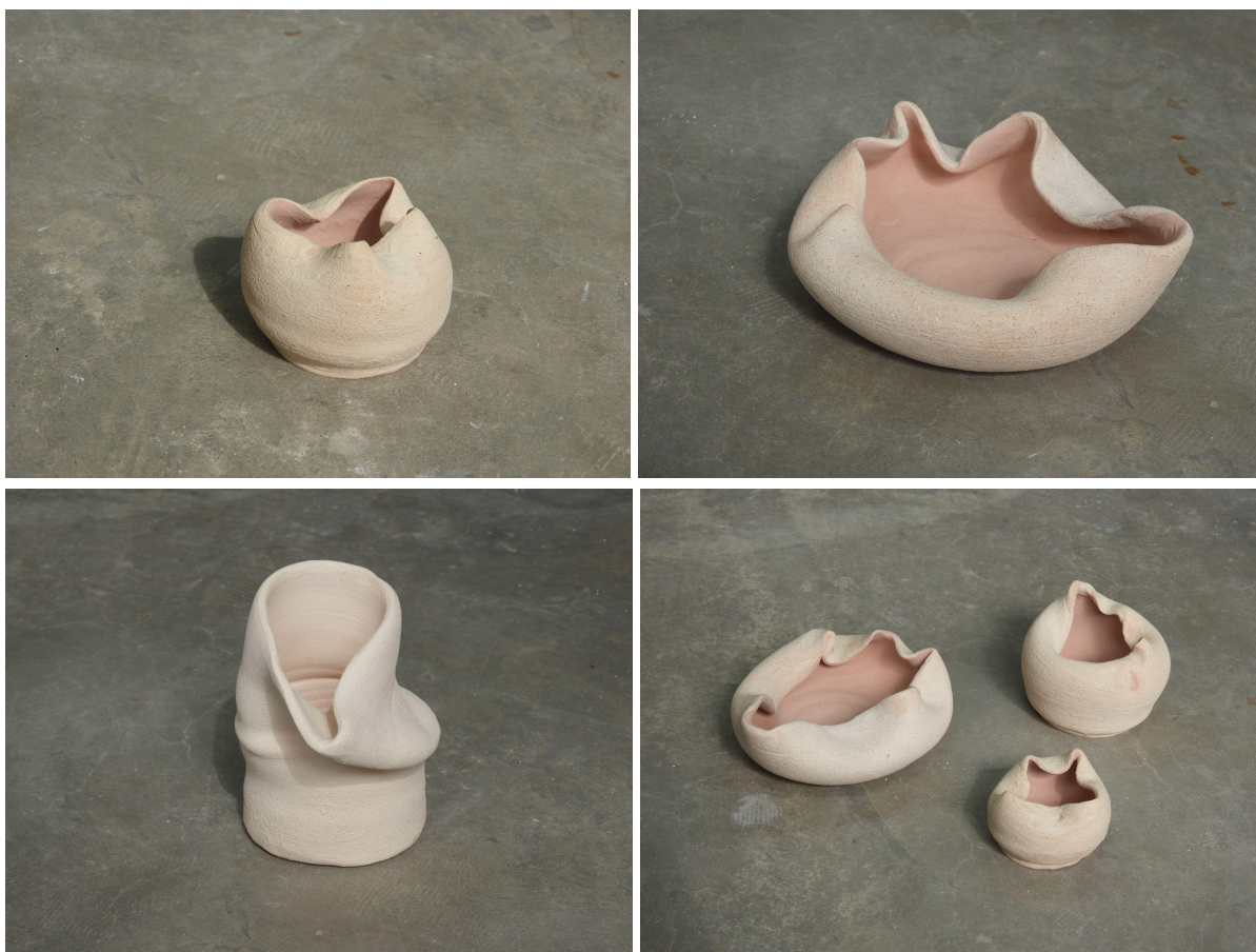
Figura 2: Conjunto de fotos de peças feitas no torno, já biscuitadas e com esmalte aplicado no interior, antes da segunda queima.
