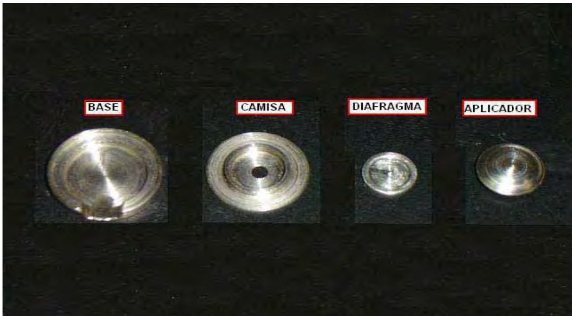
Figura 3.22 - Foto das peças que constituem as células de carga.
