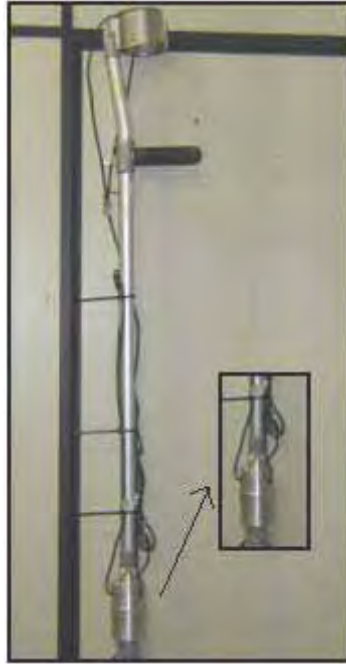
Figura 3.40 - Muleta instrumentada e detalhe do transdutor.
