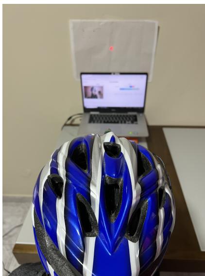
Figura 62 – Visualização do indivíduo com o capacete posicionado a 80 cm do computador para realização de testes dinâmicos
