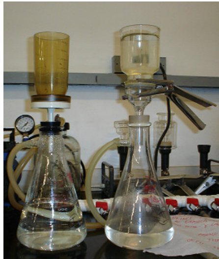
Figura 6: Sistema de filtração manifold
