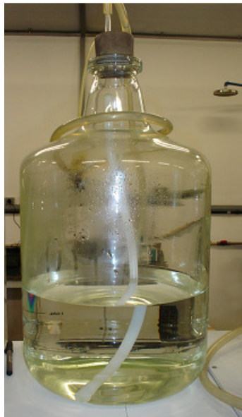
Figura 3: Sistema de aeração da água
