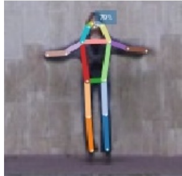
Figura 40 – Exemplo de imagem do esqueleto gerada pelo método PifPaf.
