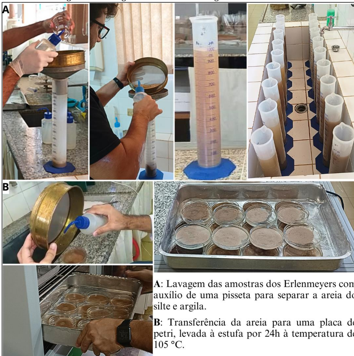
Figura 58 - Lavagem das amostras + secagem da areia na estufa.
