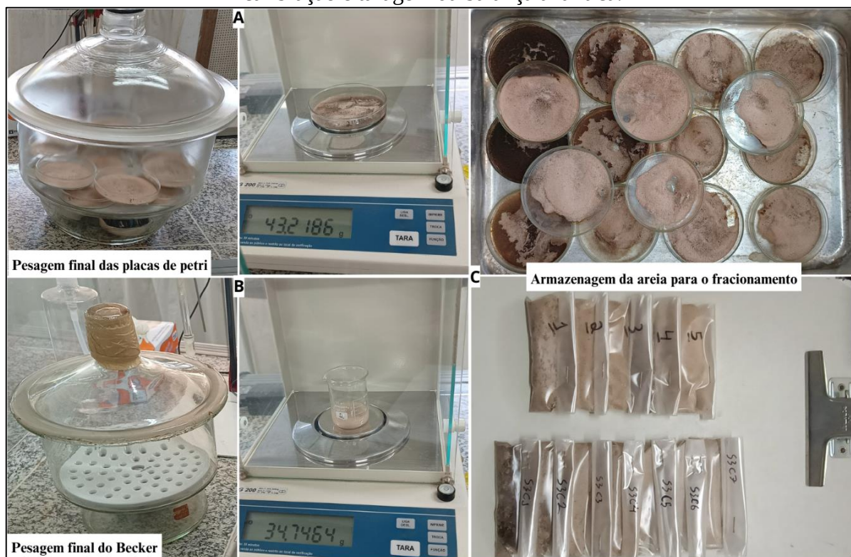
Figura 60 - Pesagem final das vidrarias (placas de petri com areia e beckers com argila) após calibração e taragem da balança analítica.
