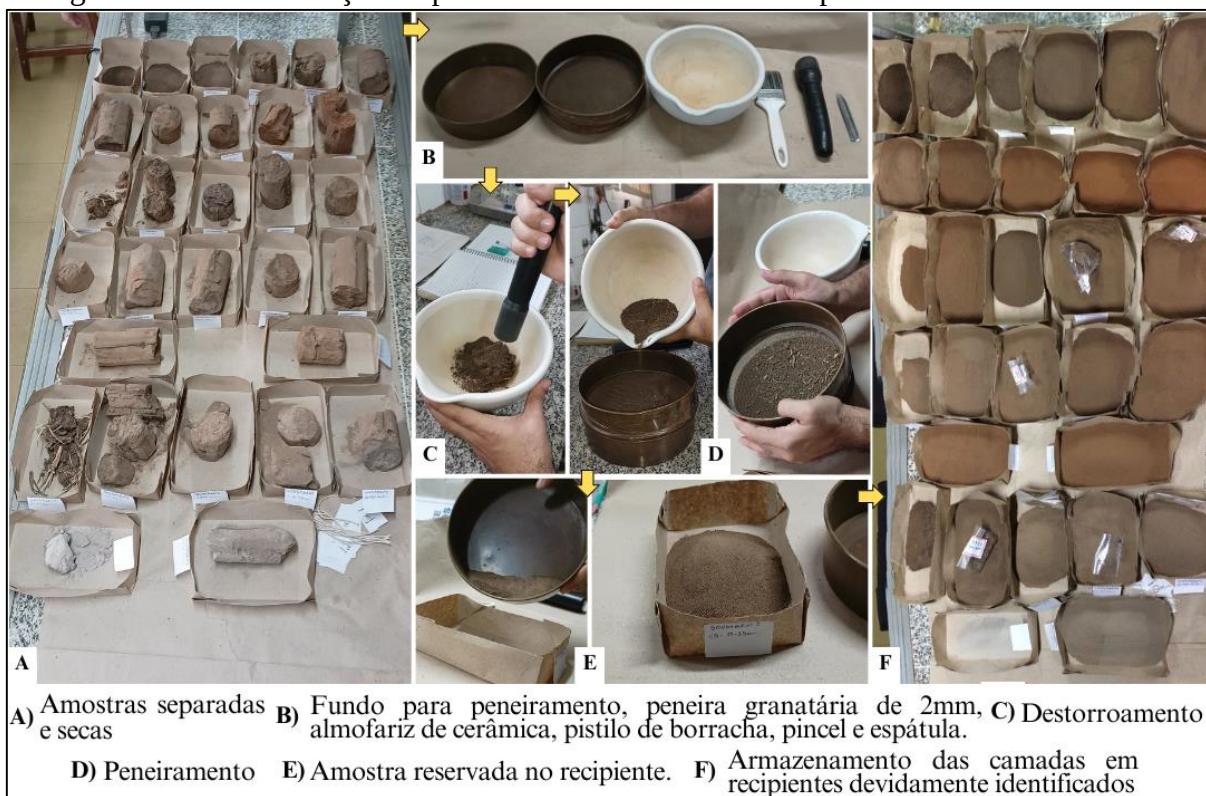
Figura 56 – Demonstração do processo de destorroamento e peneiramento das amostras.
