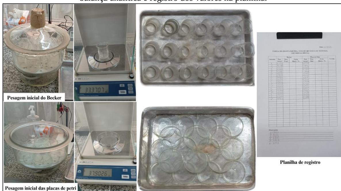
Figura 55 - Pesagem inicial das vidrarias (placas de petri e beckers) após calibração da balança analítica e registro dos valores na planilha.
