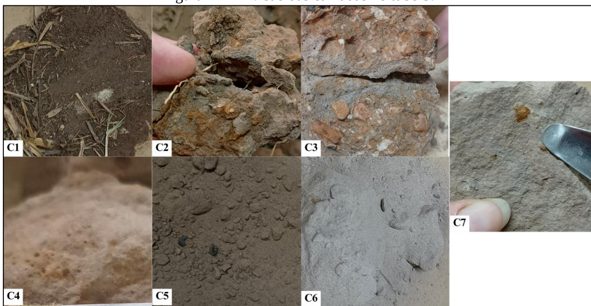
Figura 74 - Divisão das camadas no tubo 3.
