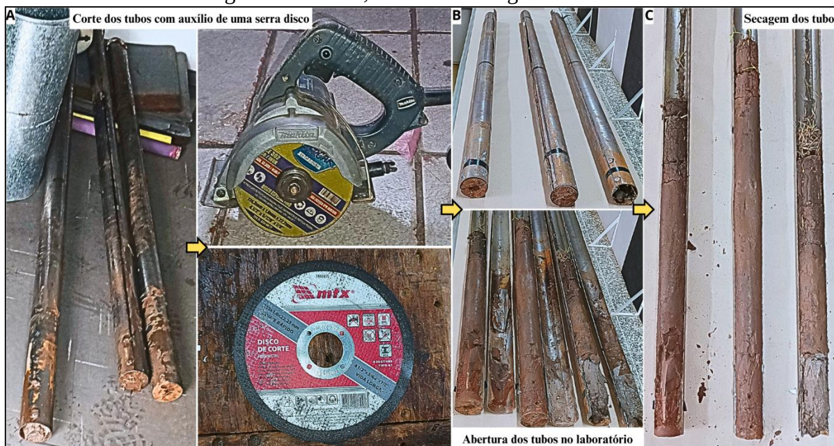
Figura 52 – Corte, abertura e secagem dos tubos.
