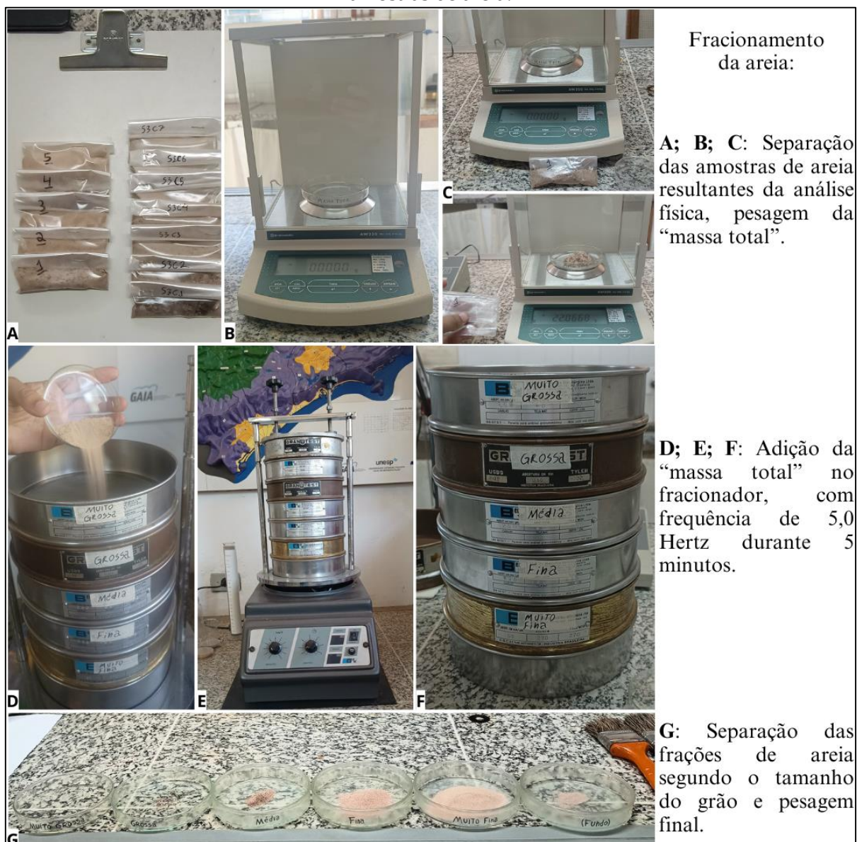
Figura 62 – Representação do procedimento de separação, pesagem e fracionamento das amostras de areia.
