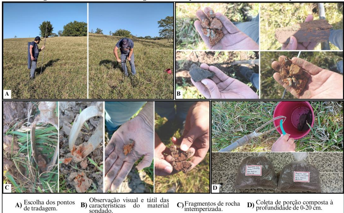
Figura 43 - Processo de tradagem em campo e coleta de amostra composta.
