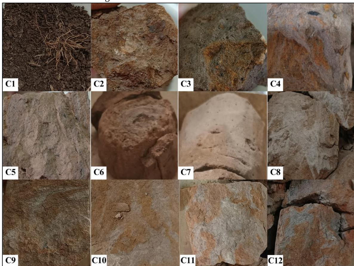
Figura 72 - Divisão das camadas no tubo 2.
