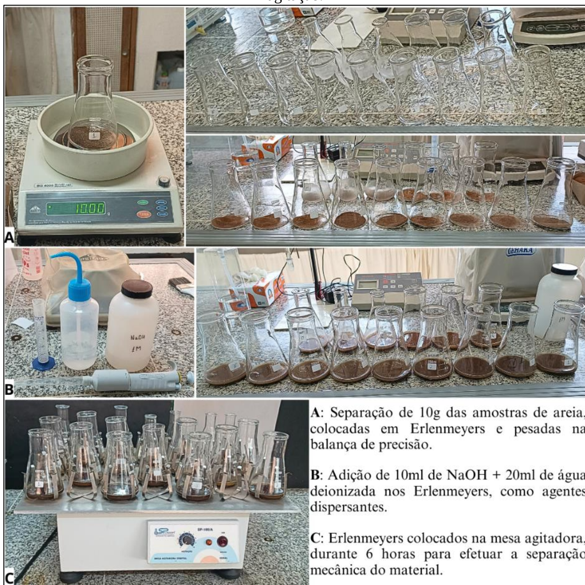
Figura 57 - Pesagem das frações de 10g de amostras, adição de NaOH + água deionizada e agitação.
