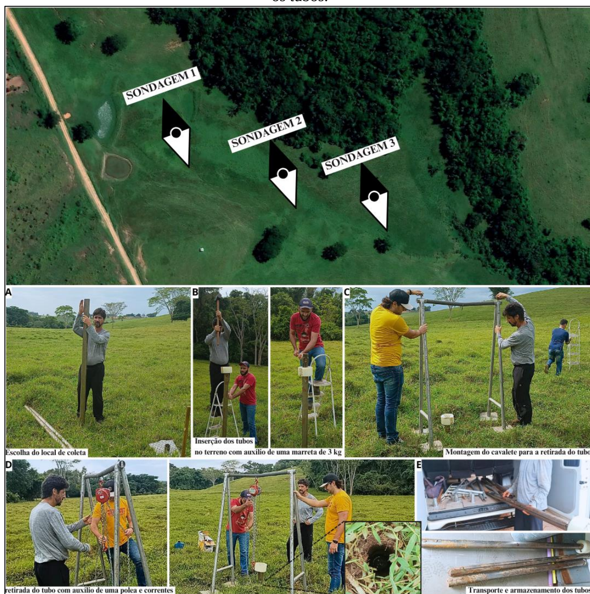
Figura 49 – Localização dos pontos de coleta e representação do procedimento de coleta com os tubos.
