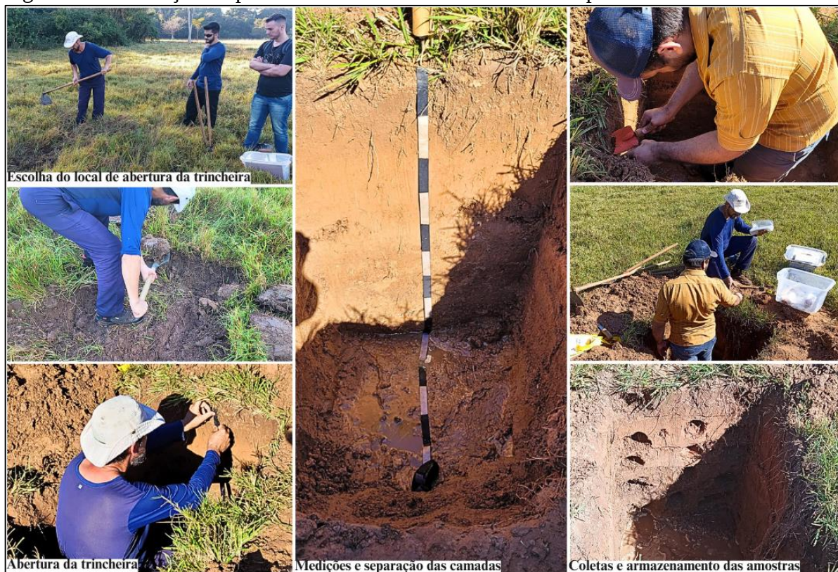
Figura 48 – Ilustração do processo de abertura da trincheira e respectivas coletas de amostras.
