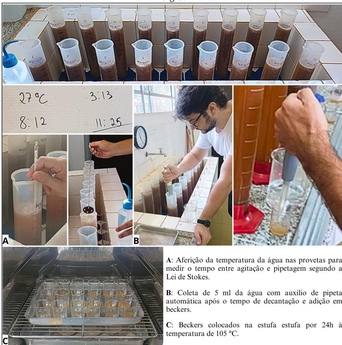
Figura 59 – Procedimentos de aferição da temperatura, agitação, pipetagem e secagem da argila.
