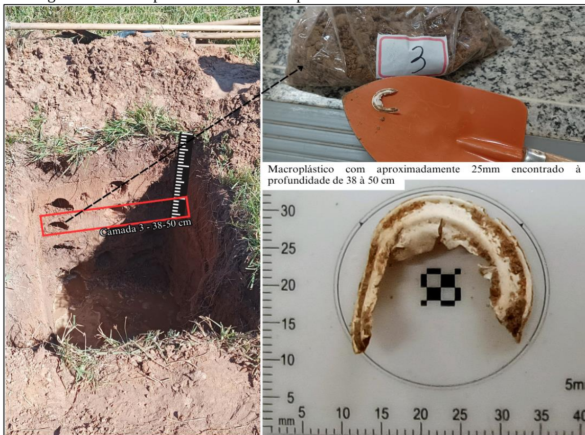
Figura 68 - Macroplástico encontrado à profundidade de 38-50 cm na trincheira.
