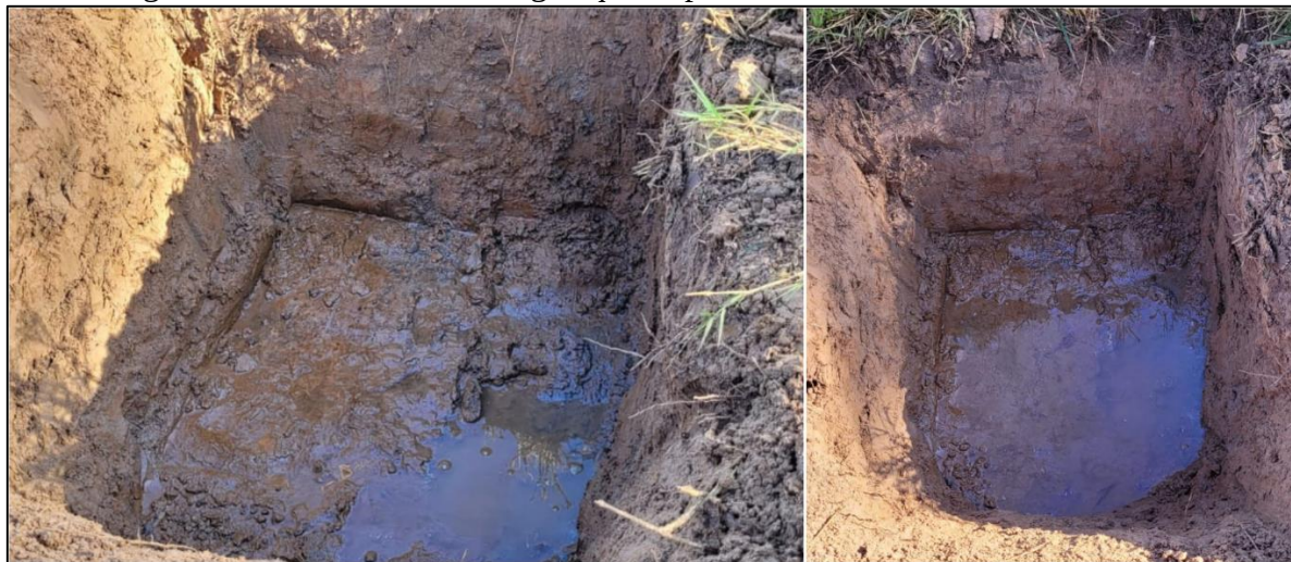
Figura 47 - Afloramento de água que impediu a coleta nas outras trincheiras.
