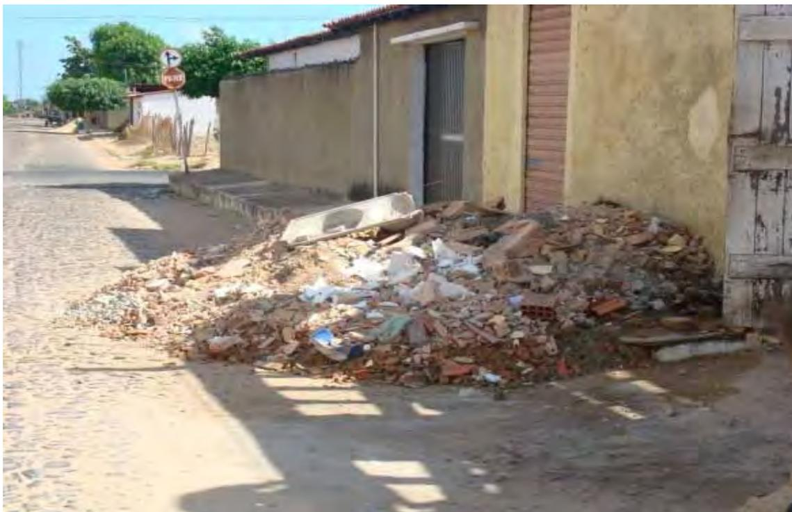
**Figura 5.5 - Obstrução da Drenagem por RCD em Parnaíba/PI**
