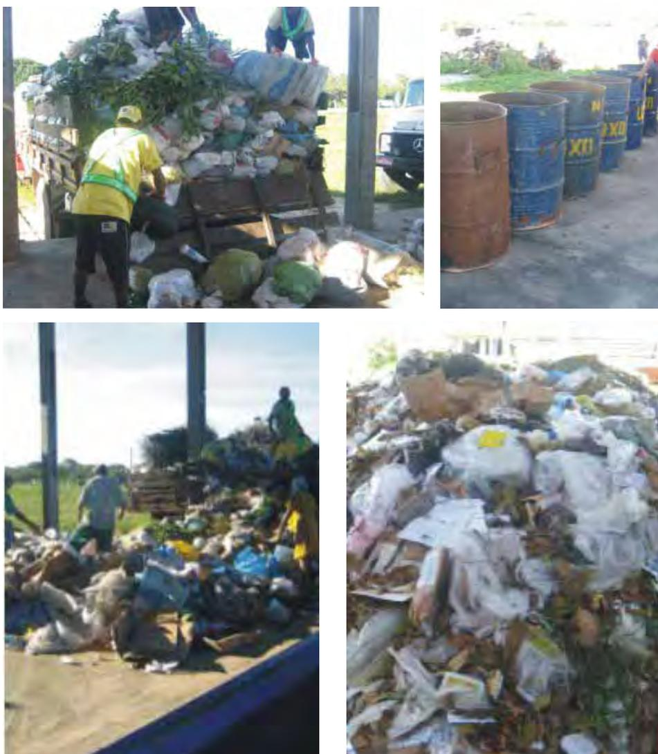
**Figuras 5.2 - Ensaio para a determinação da composição gravimétrica**
