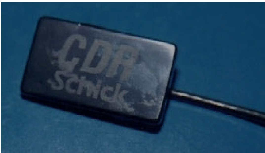
Figura 3 - Sensor (CCD) do sistema de radiografia digital direta utilizado (Schick Technologies Co., USA).
