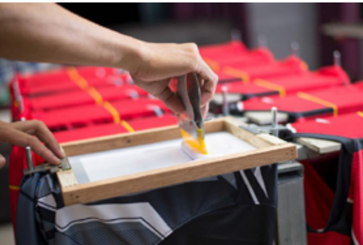
FIGURA 27: MÉTODO DE SERIGRAFIA. FONTE: STAMPINNY.
