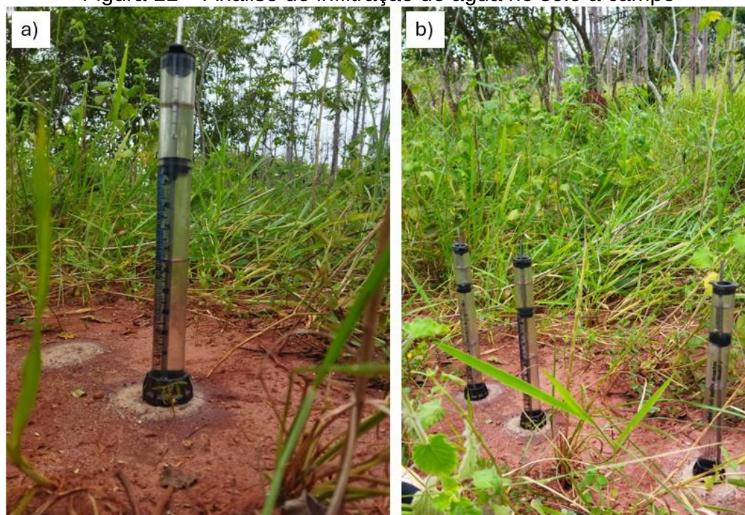
Figura 11 – Análise de infiltração de água no solo à campo
