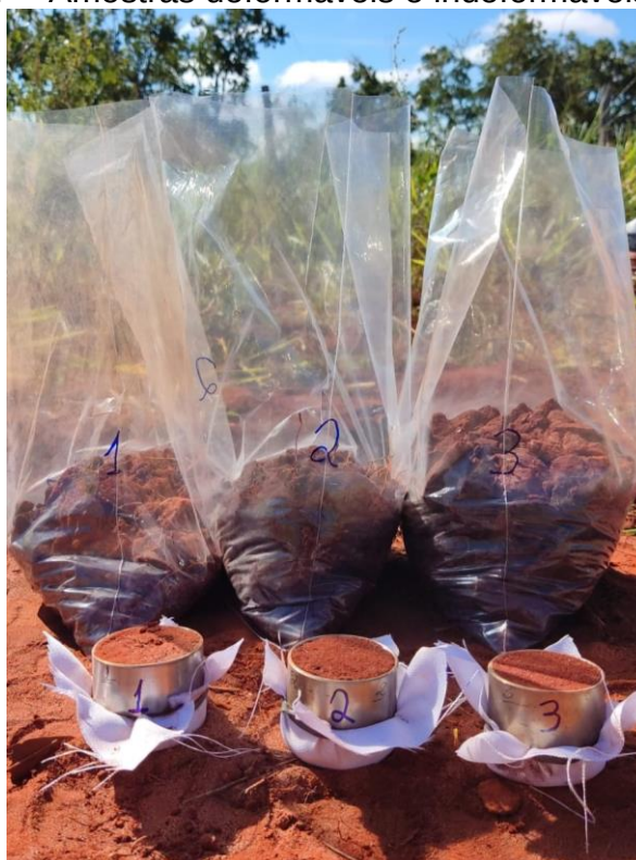
Figura 7 – Amostras deformáveis e indeformáveis do solo
