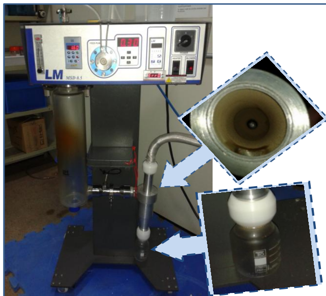
Figura 4.3: Secagem do EEB no spray dryer sem adição de adjuvantes. Destaques: Schott e ciclone ao final da secagem.
