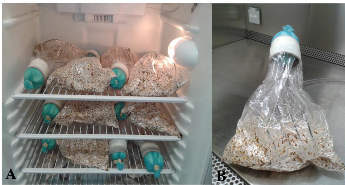
Figura 3.1: Embalagem de polipropileno para CES com o fungo Myceliophthora thermophila M77 após o período de incubação de 96 h em DBO a 45 °C (Figuras A e B).
