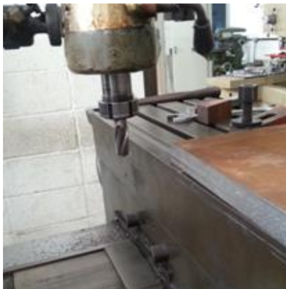
Figura 44: Fresamento das laterais das chapas e chanfro das juntas.
