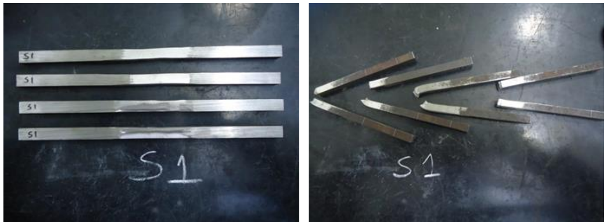
Figura 82: Ensaio de dobramento - Condição de soldagem S1
