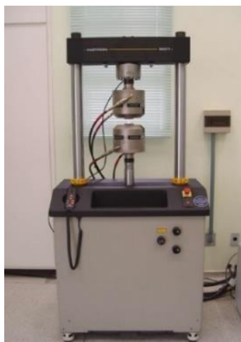
Figura 51: Equipamento de ensaio universal – Modelo INSTRON 8801
