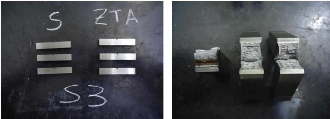
Figura 79: Ensaio de Impacto - Condição de soldagem S3
