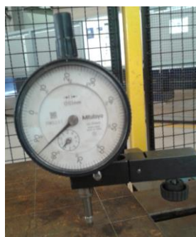
Relógio comparador Fabricante: Mitutoyo Escala: 0,01 mm
