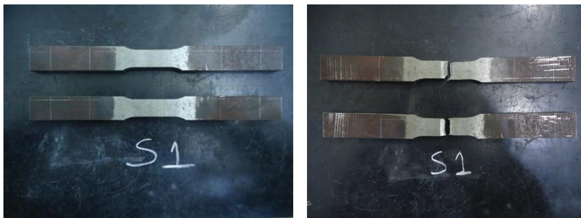
Figura 74: Ensaio de Tração - Condição de Soldagem S1
