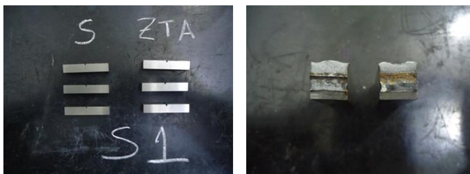
Figura 77: Ensaio de Impacto - Condição de soldagem S1
