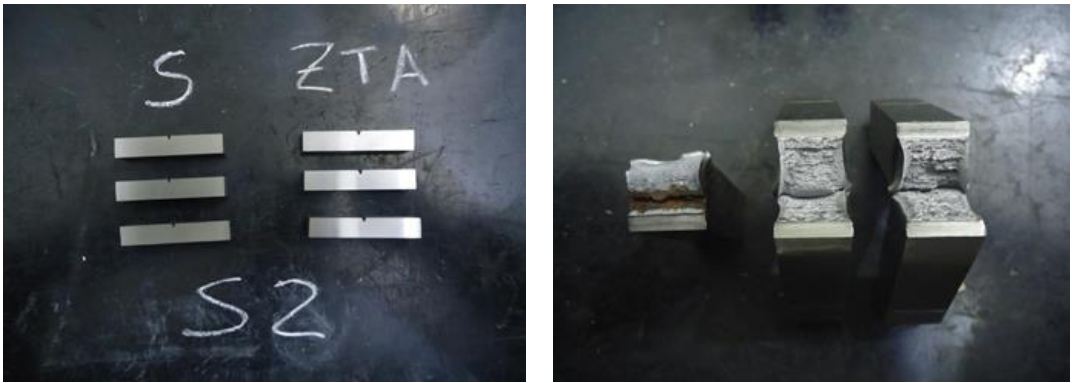
Figura 78: Ensaio de Impacto - Condição de soldagem S2
