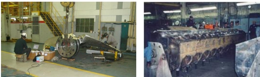
Figura 35: Exemplos de tratamento vibracional com fixação diretamente no componente.
