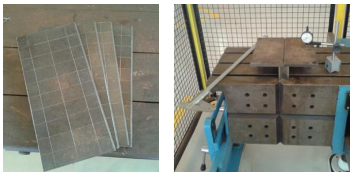
Figura 47: Divisão das chapas em quadrantes e análise de deformações.
