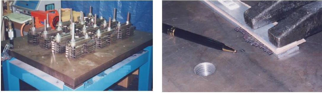
Figura 36: Exemplos de tratamento vibracional com o auxílio de uma mesa de vibração.
