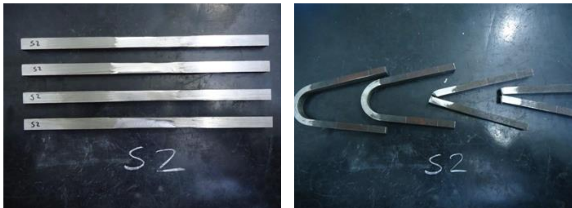
Figura 83: Ensaio de dobramento - Condição de soldagem S2
