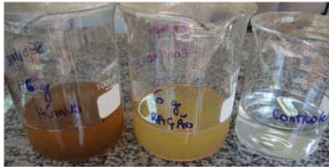
Figura 8: Preparação das amostras de matéria orgânica para análise de N, P e TOC
