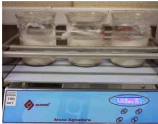
Figura 14: Condicionamento do sedimento formulado: etapa de agitação por 2h a 175 rpm
