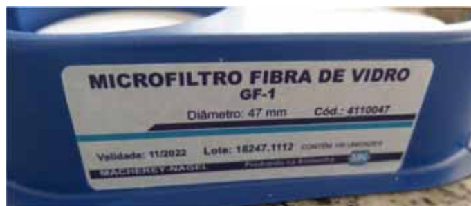
Figura 16: Microfiltro de fibra de vidro utilizado no preparo de amostras previamente à etapa de SPE
