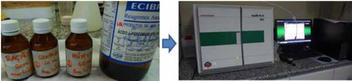
Figura 12: Amostras para análise de TOC e equipamento de medição de TOC
