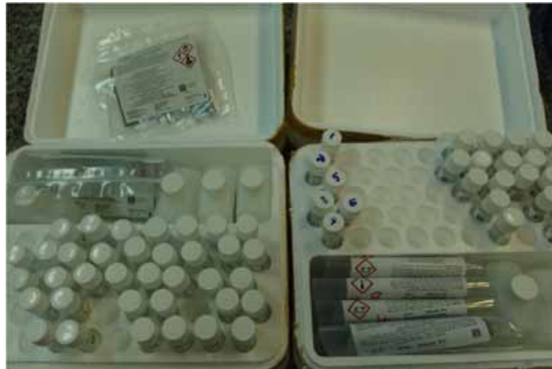
Figura 10: Kit Hach utilizado para determinação de nitrogênio total em amostra líquida
