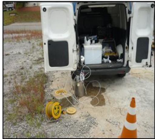
Foto 2 - Equipamentos utilizados na amostragem de água subterrânea.
