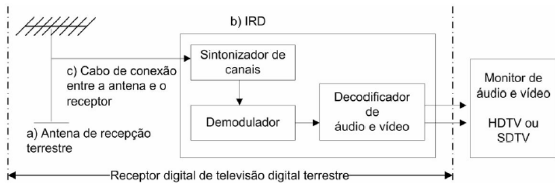
Figura 13 - Configuração básica de um STB, segundo norma da ABNT.
