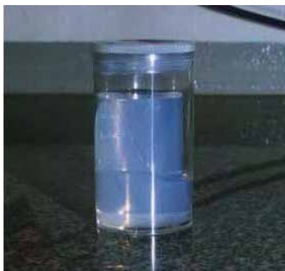
Figura 26: Gel puro preparado em recipiente cilíndrico, após envelhecimento de 5 dias a 40 °C. Frasco com diâmetro interno de 3,5 cm.
