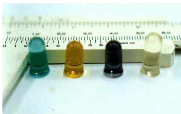
(d) Xerogeis dopados com Cromo, Ferro, Cobre e Estrôncio.
