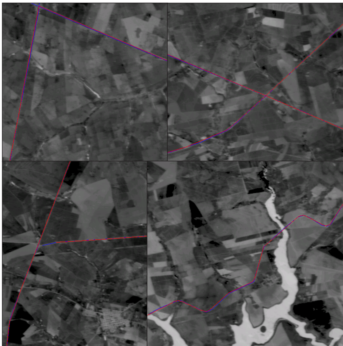
Figura 30 – Experimento 4: rodovias extraídas e as correspondentes projetadas após a convergência do processo de orientação.
