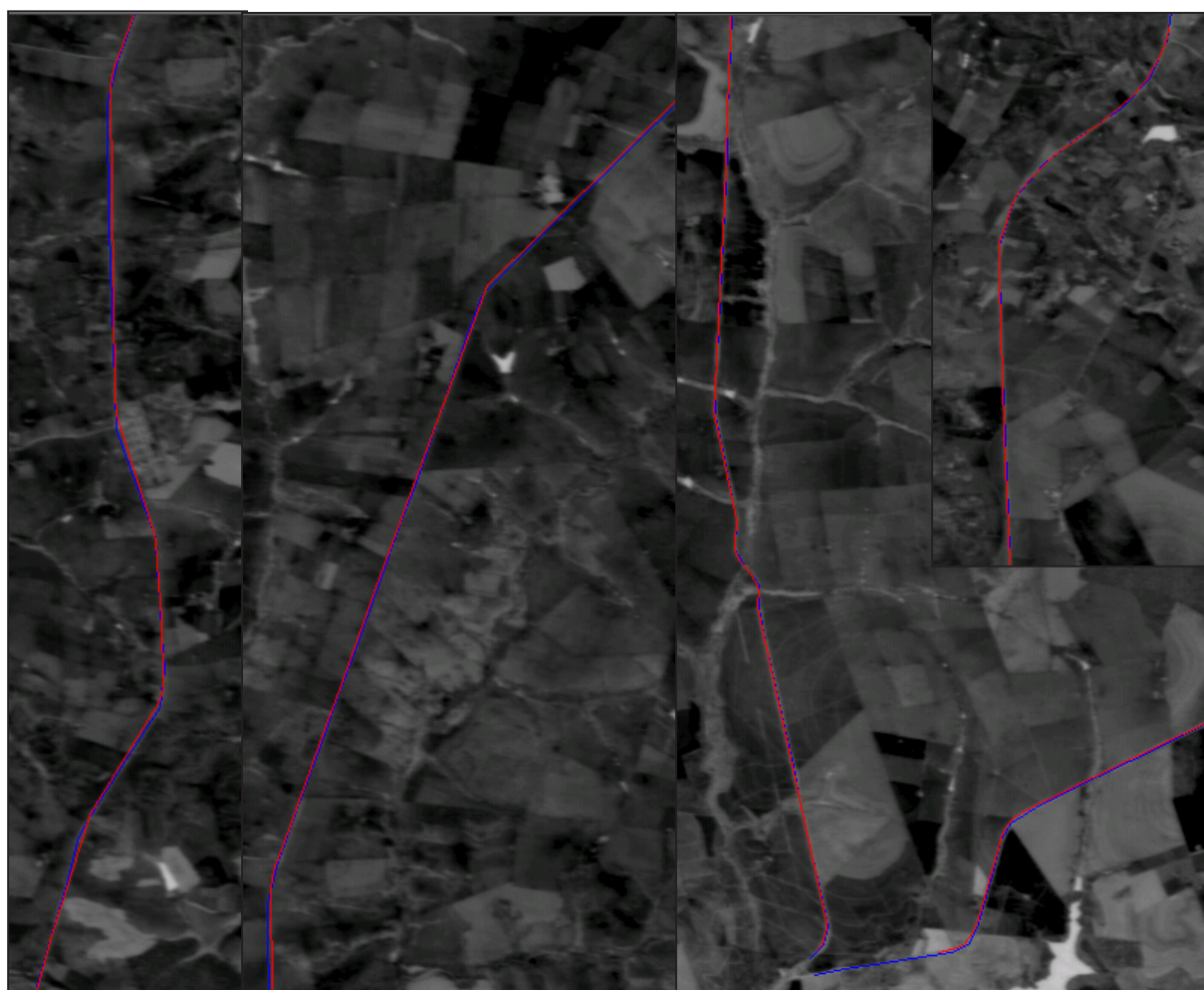
Figura 26 – Experimento 3: rodovias extraídas e as correspondentes projetadas após a convergência do processo de orientação.
