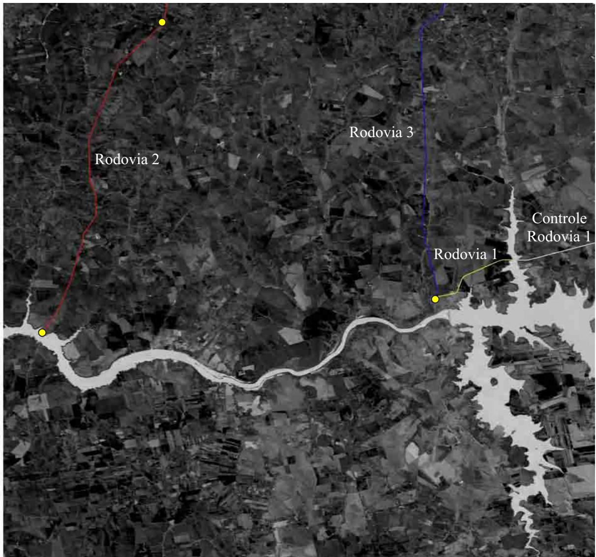
Figura 24 – Parte inferior esquerda da imagem e as rodovias utilizadas no processo de orientação e na avaliação.
