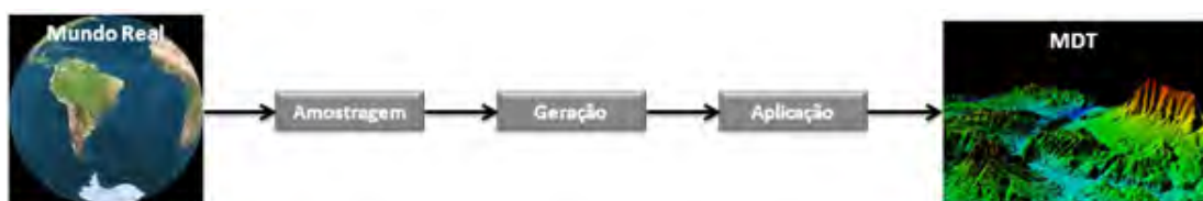
Figura 2.4: Principais etapas na geração de um MDT.
