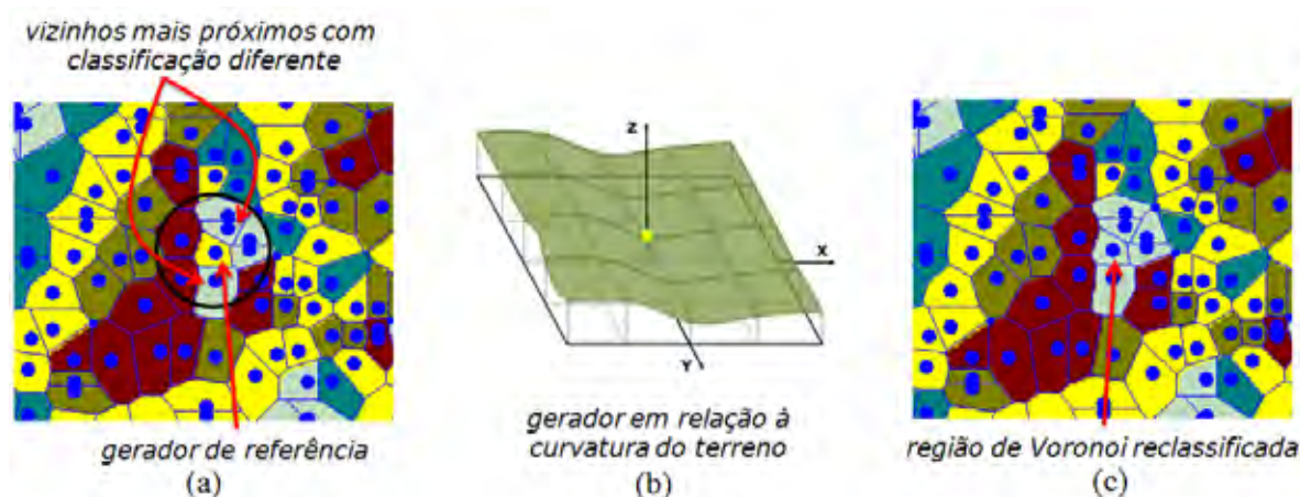
Figura 5.36: Exemplo de reclassificação: (a) região de Voronoi e sua relação de vizinhança com outras áreas; (b) curvatura no MDT; (c) região reclassificada.
