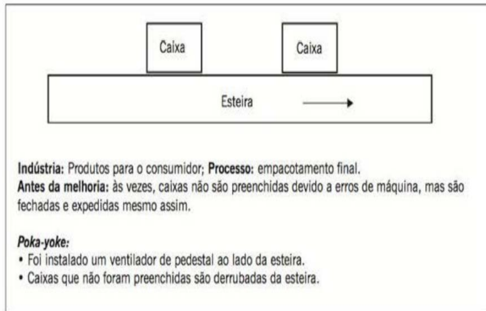
Figura 16 - Exemplo Figurativo de Poka-Yoke
