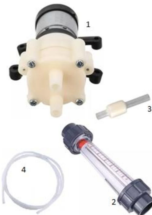
Figura 3 – Conjunto Kit de amostragem aparatos ( 1 bomba, 2 rotâmetro, 3 C18 e 4 tubos teflon)
