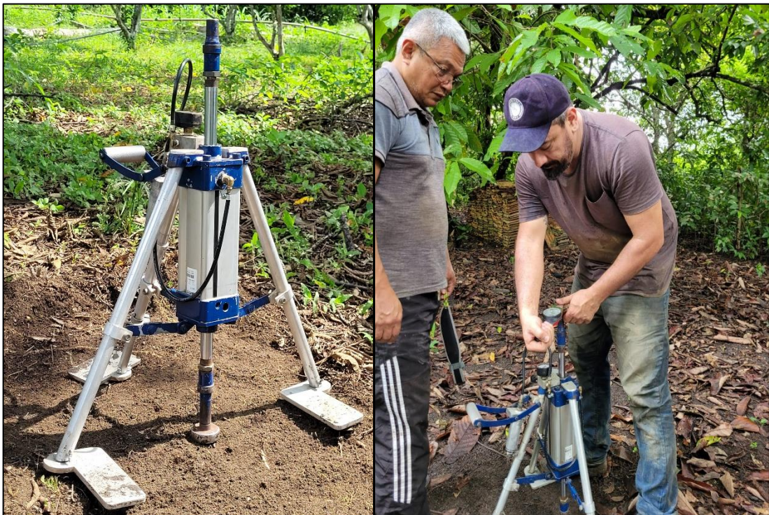
Figura 4. Coleta de dados no campo para avaliação da resistência do solo ao cisalhamento, utilizando um cislhometro desenvolvido por Silva e Lanças (2006).
