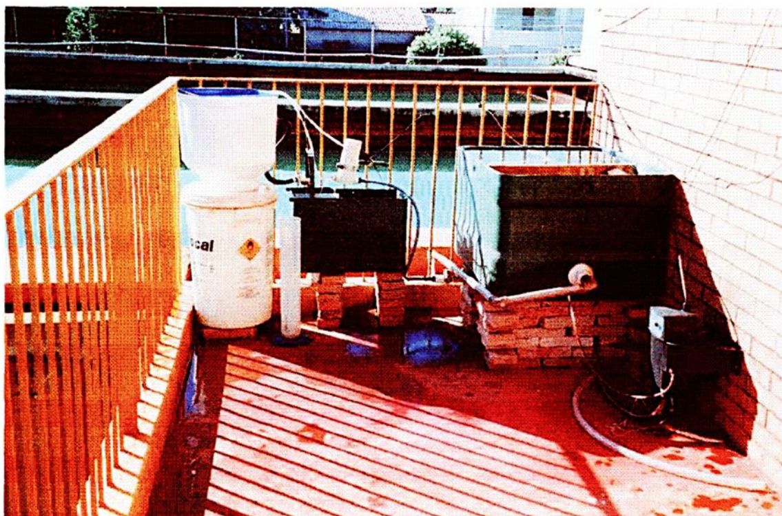
Figura 4.9- Câmara de contato entre a água bruta e o coagulante.
