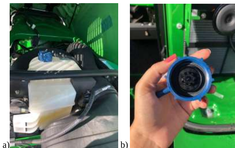
Figura 2 - Alguns dos possíveis pontos de contaminação no sistema de arrefecimento do motor (Trator modelo 6100J).
