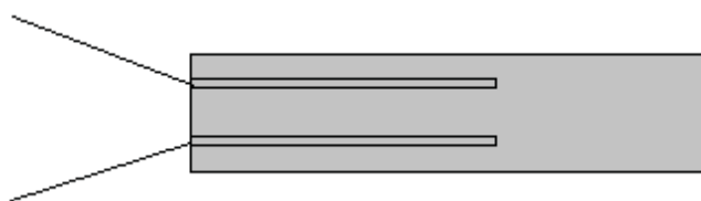
Figura 12 – Extensômetro soldável (DALLY; RILEY, 1978).
