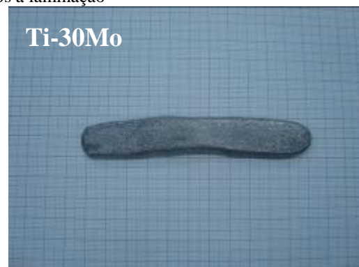
Figura 13: Amostras após a laminação
