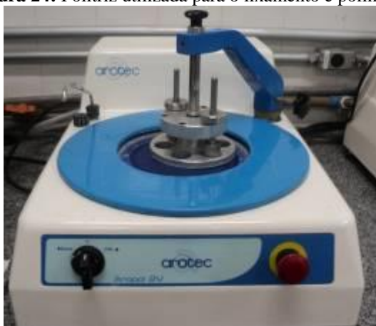
Figura 24: Politriz utilizada para o lixamento e polimento
