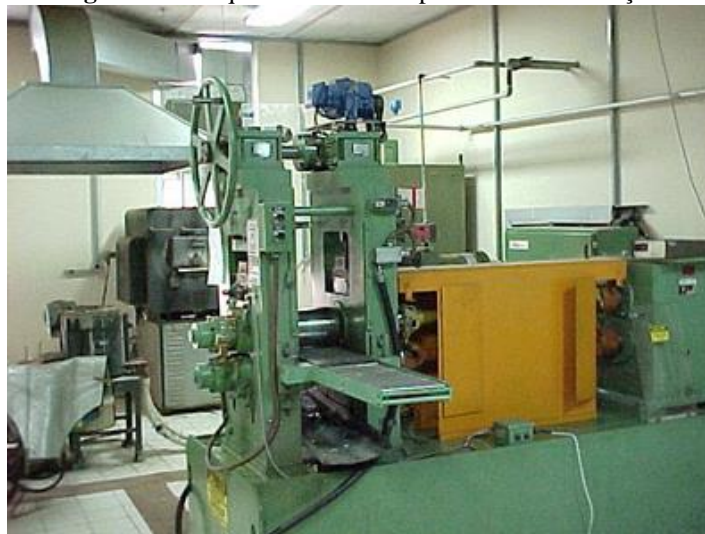
Figura 12: Máquina utilizada no processo de laminação
