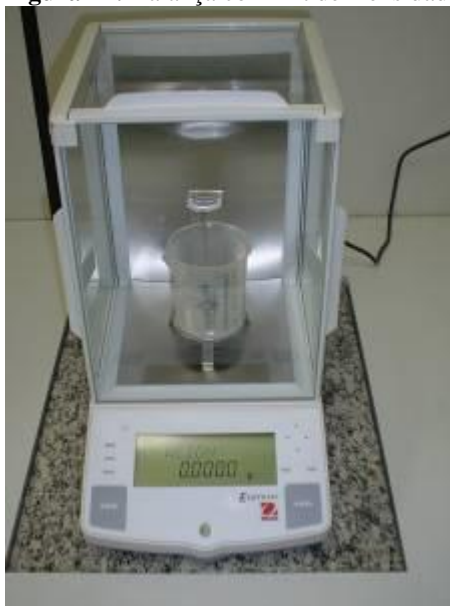
Figura 21: Balança com Kit de Densidade
