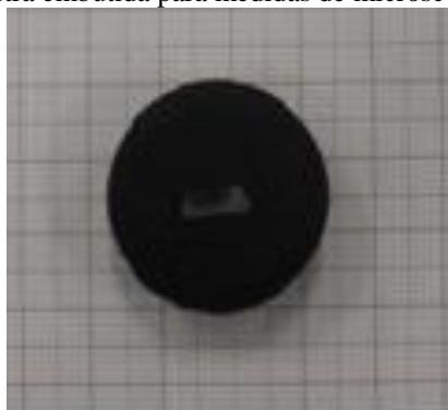
Figura 25: Amostra embutida para medidas de microscopia e microdureza
