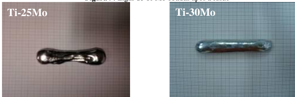
Figura 9: Ligas de Ti-Mo obtidas após a fusão
