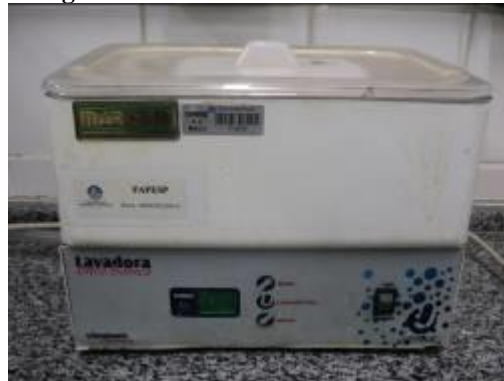
Figura 8: Lavadora ultra-sônica utilizada
