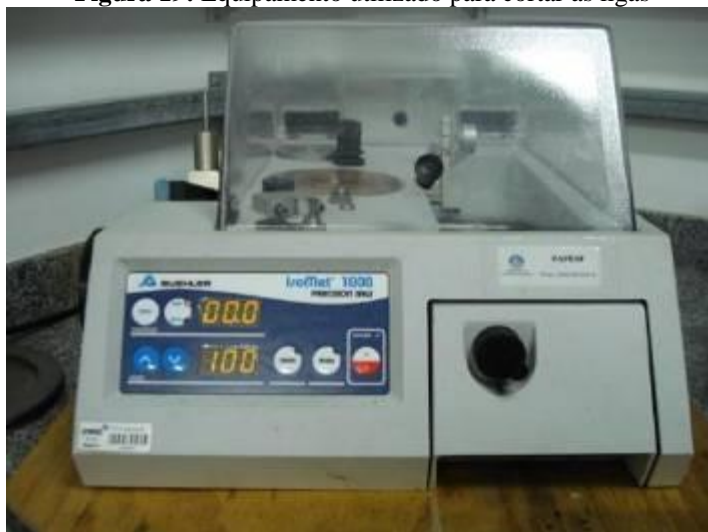
Figura 19: Equipamento utilizado para cortar as ligas
