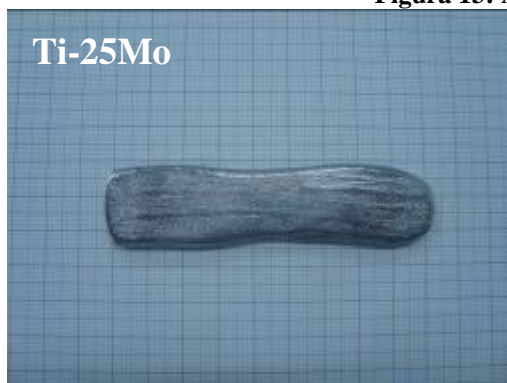
Figura 13: Amostras após a laminação
