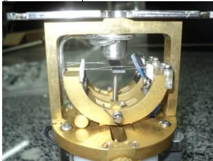
Figura 29: Porta-amostra para as medidas de Módulo de Elasticidade
