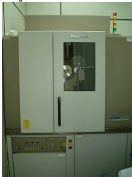
Figura 22: Difratorômetro de Raios X
