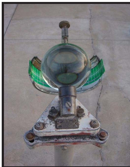
Figura 2 - Heliógrafo, marca FUESS de escala diária da Estação Meteorológica da FCT-UNESP.
