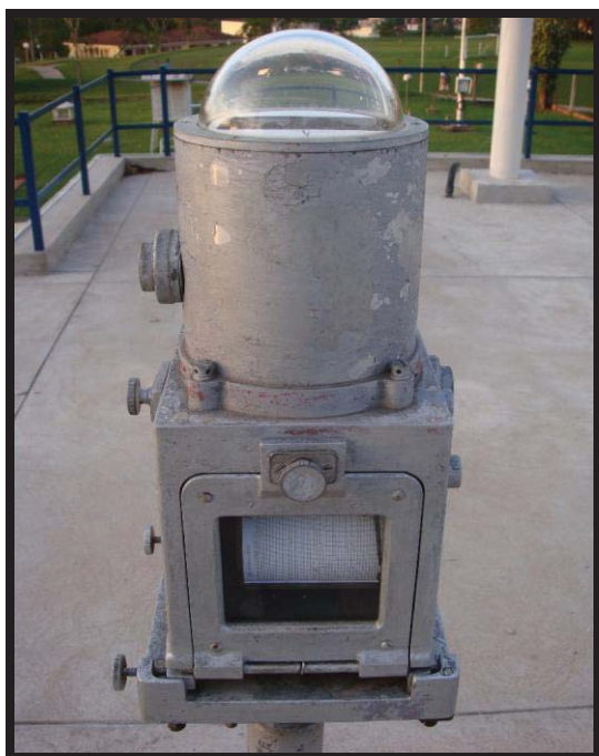
Figura 1 - Actinógrafo bimetalico de Robitchz, marca FUESS de escala semanal da Estação Meteorológica da FCT-UNESP.
