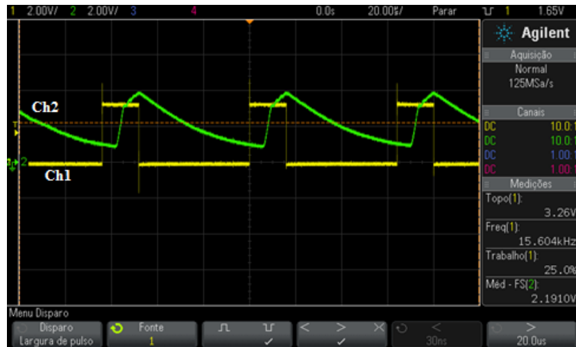
Figura 22 – Sinal de PWM com D=25% e forma de onda da tensão no motor.
