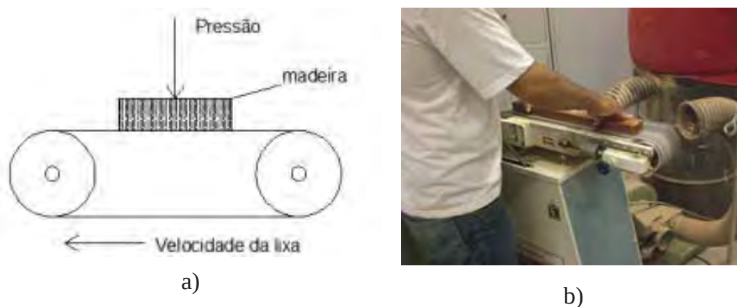
Figura 3.12 – Lixamento das amostras: a) Representação esquemática do lixamento plano. b) Lixamento das amostras antes da colagem.
