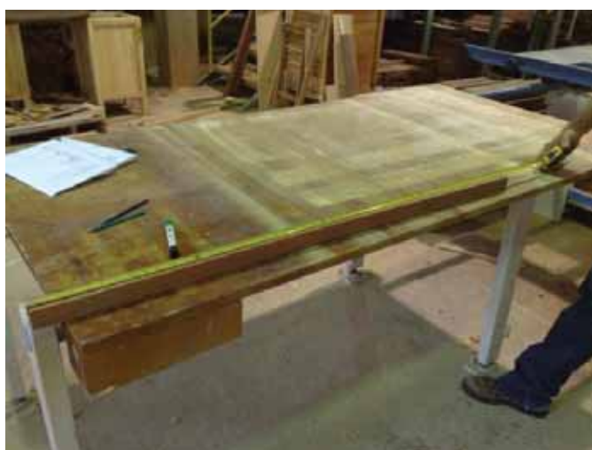
Figura 3.4 – Início da marcação das peças para confecção das amostras.
