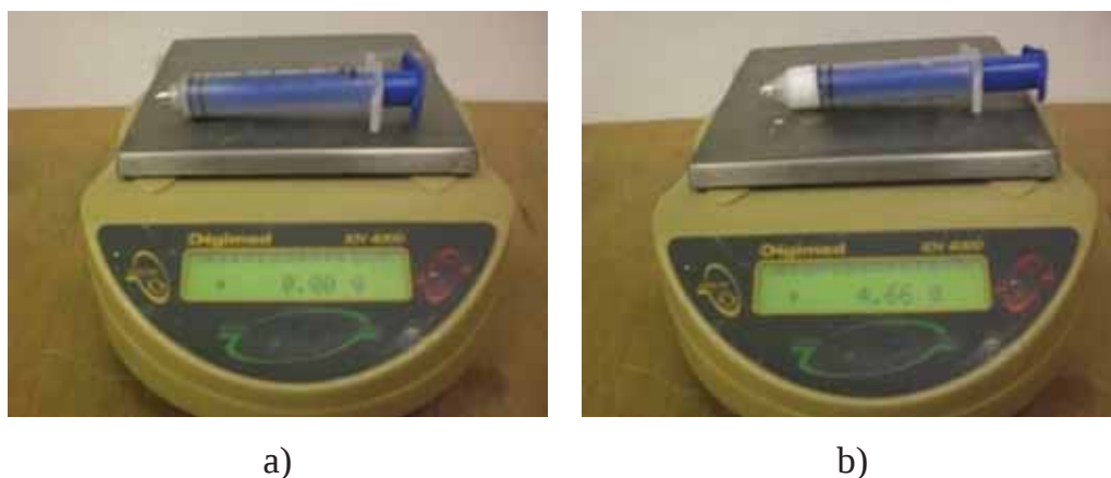
Figura 3.16 – a) Tara da balança, b) Pesagem da quantidade de cola. (medida registrada 4,66 g)
