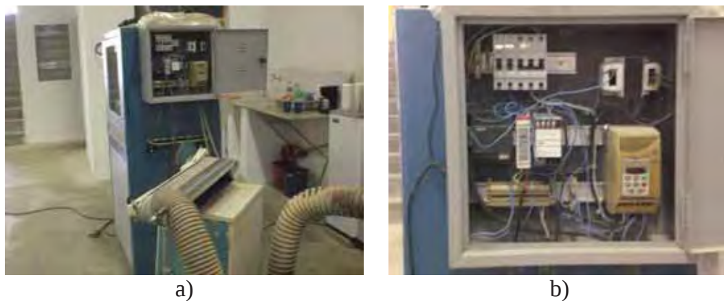
Figura 3.9 – Lixadeira utilizada: a) Conjunto lixadeira e Painel de controle, b) Detalhe: Painel de controle.
