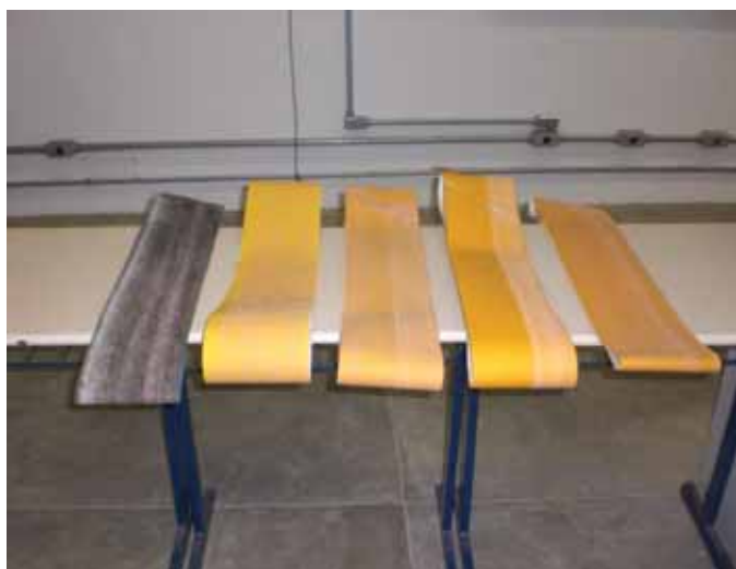
Figura 3.10 - Lixas utilizadas P80, P100, P120, P150 e P220 (direita para esquerda).
