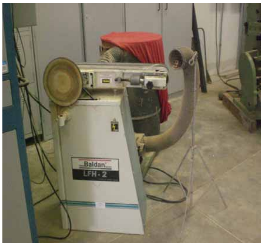
Figura 3.8 – Lixadeira de cinta de mesa horizontal empregada no lixamento das superfícies.
