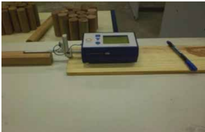
Figura 3.15 – Medição da rugosidade nas superfícies usinadas, vista geral em utilização.
