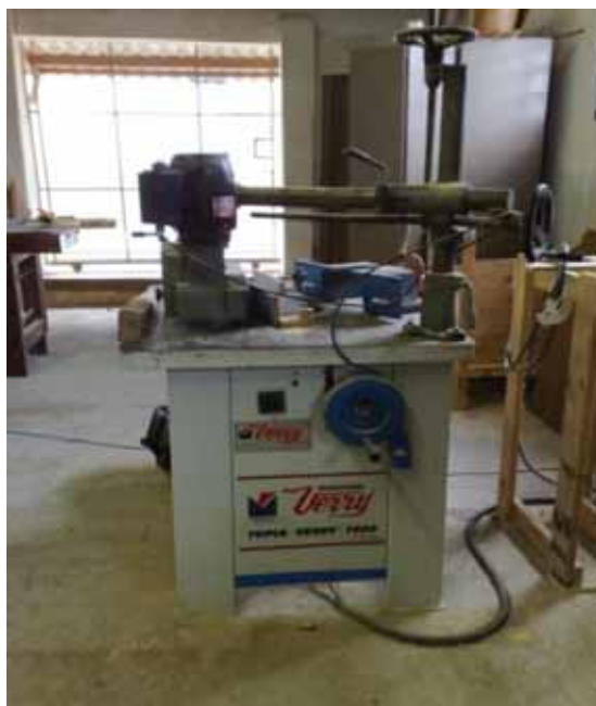
Figura 3.6 - “Tupia Moldureira” equipada com alimentador de avanço, utilizada na geração das superfícies de colagem das peças, para posterior lixamento e produção dos CPs.
