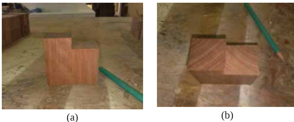
Figura 3.32 – CPs sendo preparados para submissão a ensaio de cisalhamento: (a) vista lateral e (b) vista de topo.
