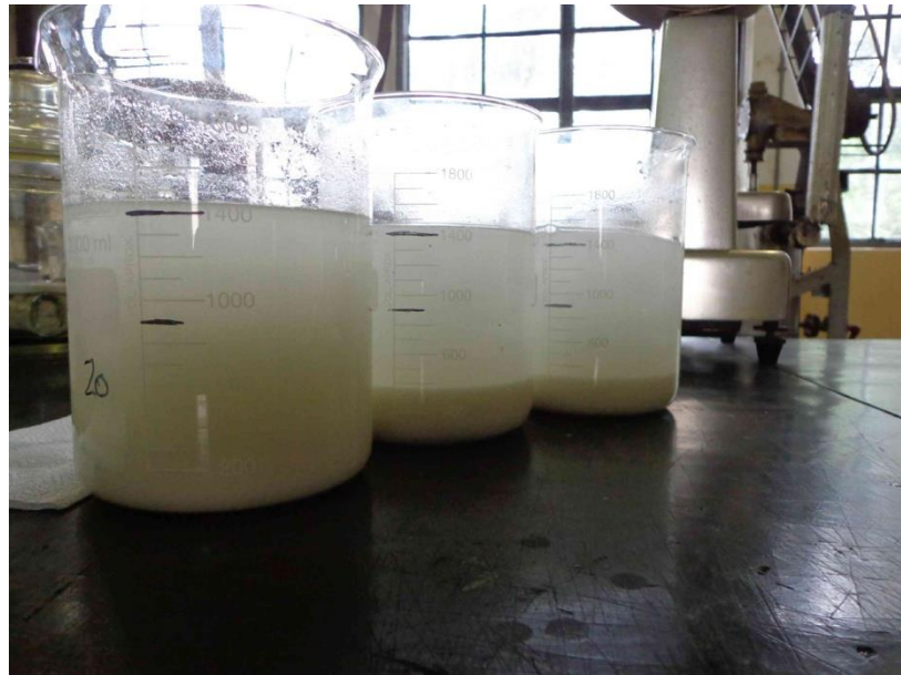
Figura 30 - Teste de lavagem da NC – Etapa de Fervimento Alcalino.
