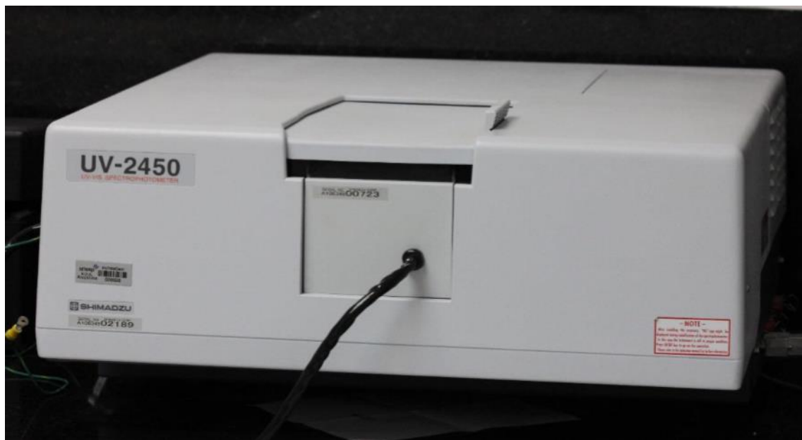
Figura 5 - Espectrofotômetro de Reflexão Ultravioleta Visível*, Modelo UV-2450 (Shimadzu, Kyoto, Japão)
