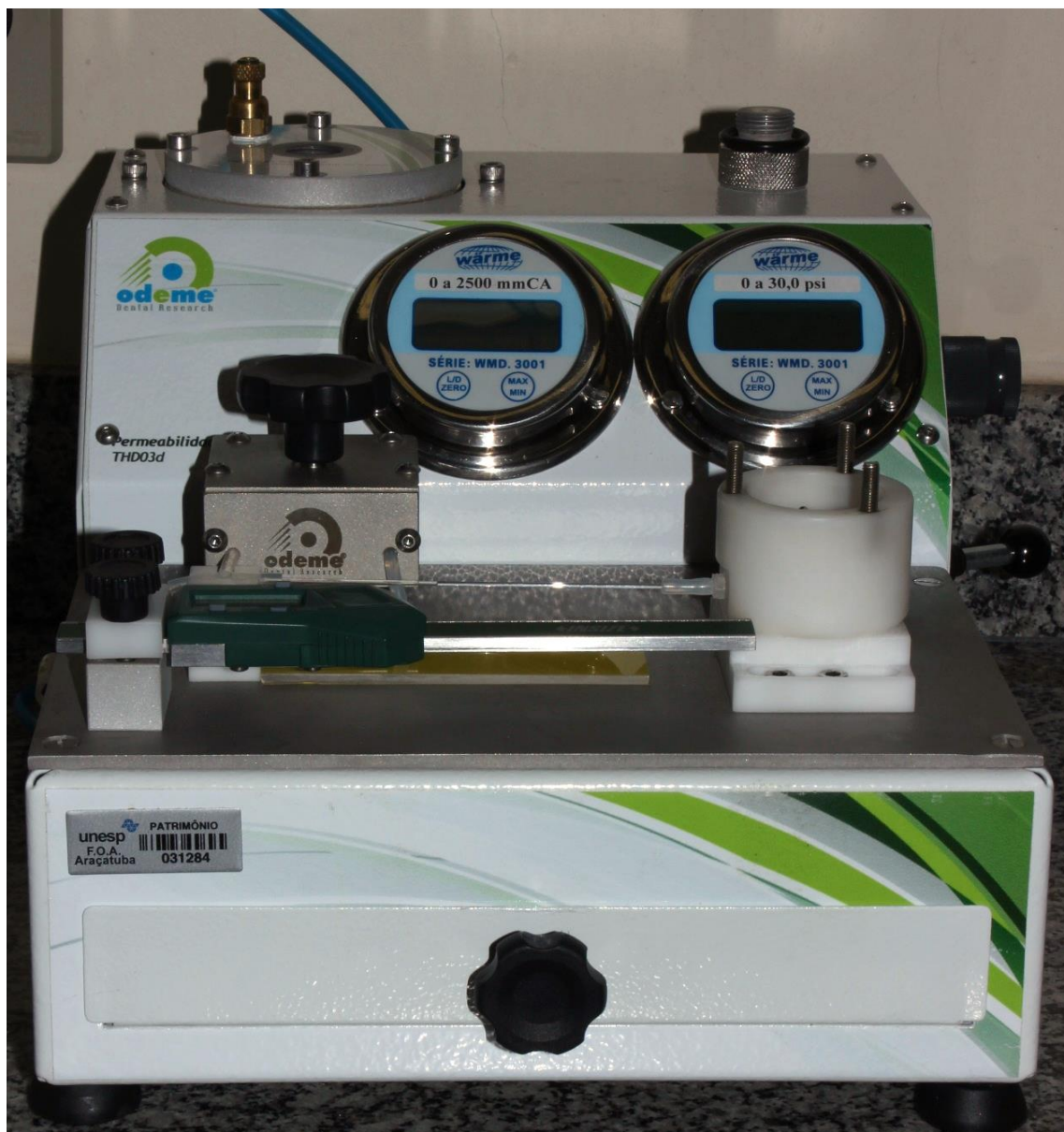
Figura 12 – Máquina de permeabilidade dentinária para realizar o teste de condutância hidráulica.
