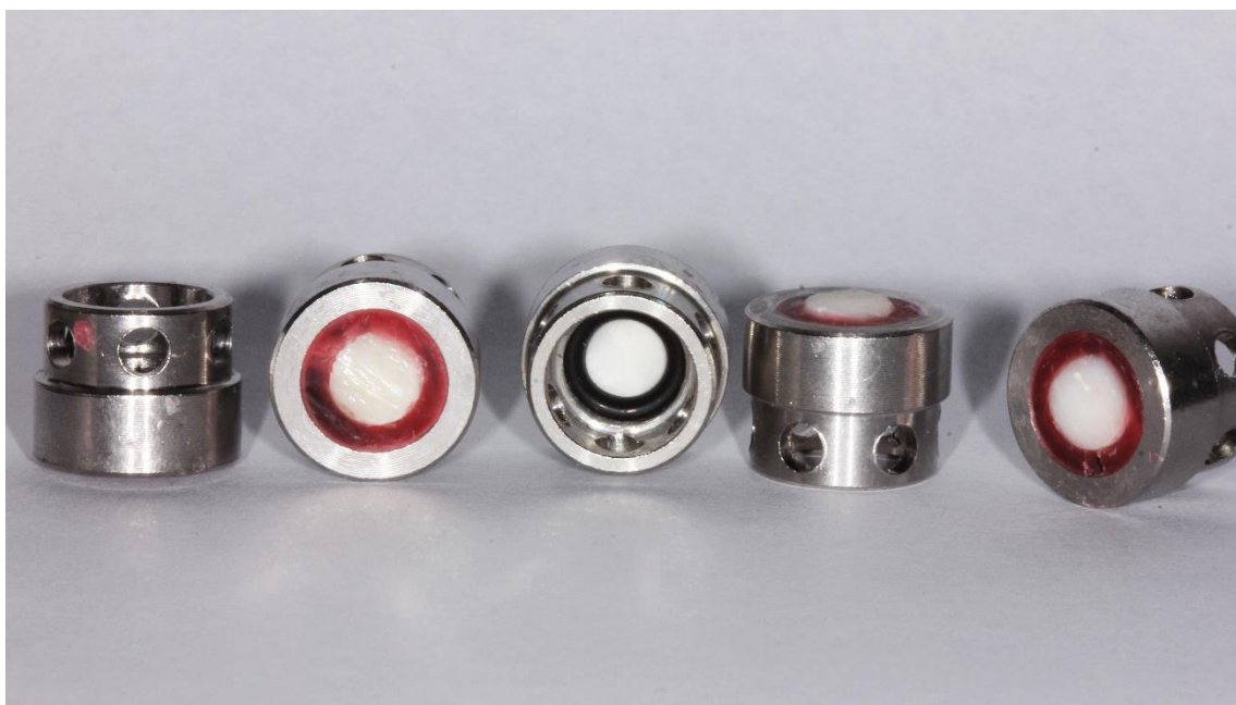
Figura 2 – Posicionamento dos espécimes na câmara pulpar artificial e vedamento com cera rosa fundida nº 7
