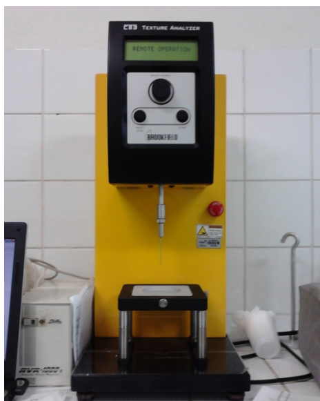
Fig. 2. Texturômetro “Texture Analyzer Brookfield” utilizado para determinação da rigidez das sementes.
