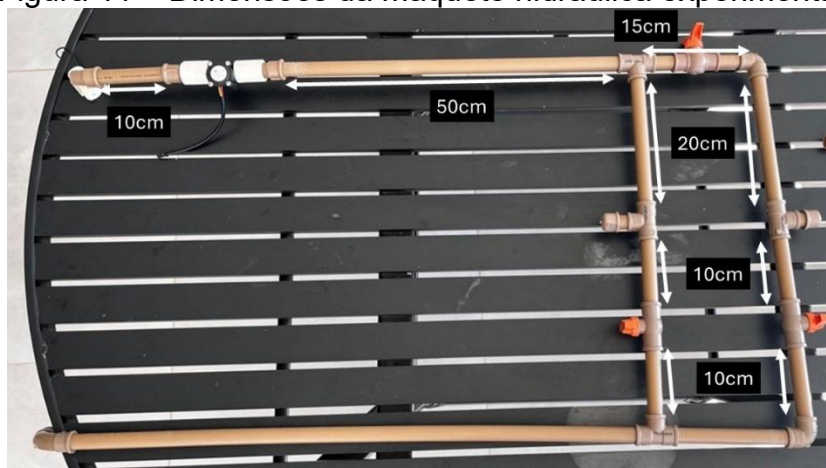
Figura 11 – Dimensões da maquete hidráulica experimental
