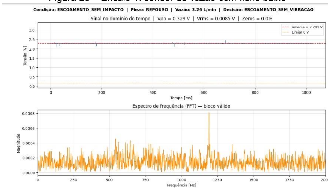
Figura 26 – Ensaio 1: sensor de vazão com fluxo baixo
