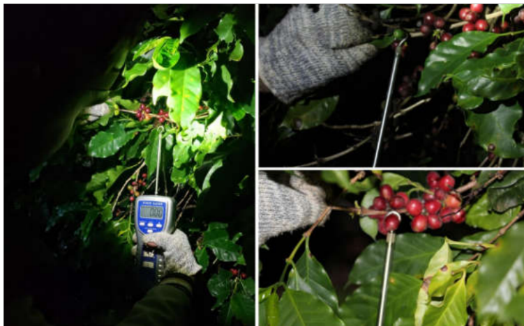
Figura 5. Mensuração da força de desprendimento dos frutos de café utilizando dinamômetro digital portátil.
