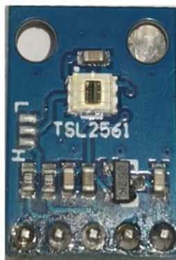
Figura 7: Sensor TSL2561. Fonte: Autor.
