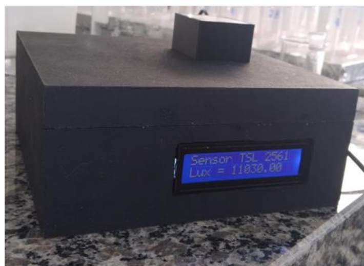
Figura 19:Fotômetro "homemade". Fonte: Autor.
