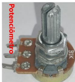
Figura 11: Potenciômetro. Fonte: Autor.
