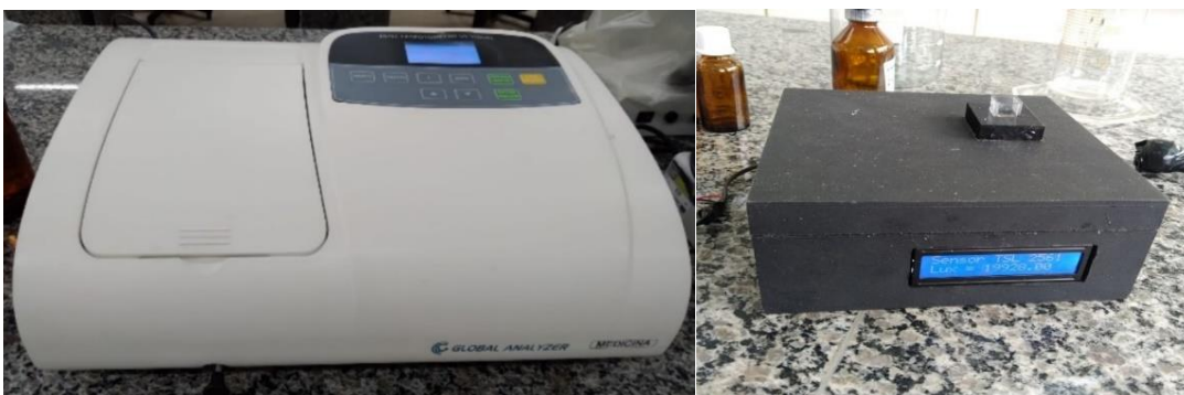
Figura 34: Espectrofotômetro Analyser e Fotômetro “Homemade”. Fonte: Autor.
