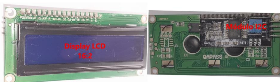
Figura 10: Display LCD 16:2 com módulo adaptador I2C Fonte: Autor.
