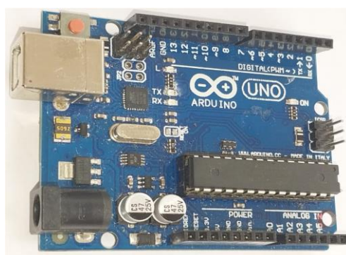
Figura 9: Placa de Arduino UNO Fonte: Autor.
