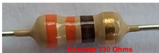
Figura 13:Resistor de 330 Ohms. Fonte: Autor.
