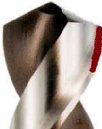
Figura 3.18 - Broca com desgaste na superfície cilíndrica
