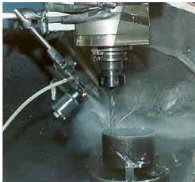
Figura 3.28 - Refrigeração à baixa pressão.
