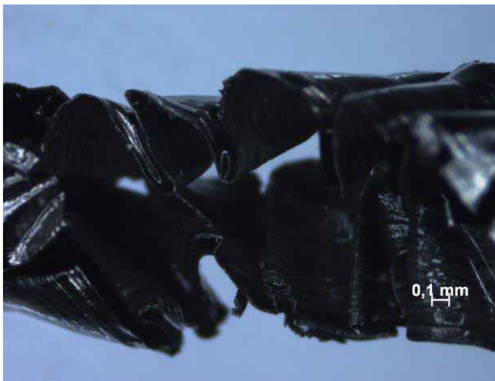
Quadro 5.14 - Sequência de fotos da broca de metal duro, à seco, sem pré-furos, aos 2000mm.
