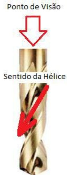
Figura 3.31 - Sentido da hélice de uma broca helicoidal
