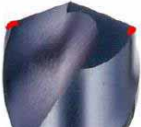
Figura 3.22 - Broca com deformação plástica dos cantos
