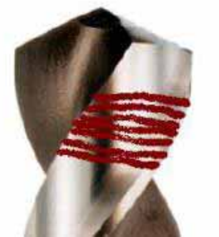
Figura 3.19 - Broca com riscos na superfície cilíndrica
