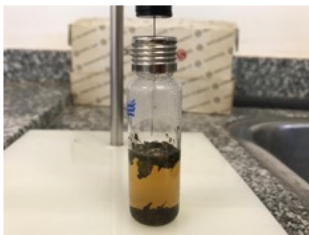
Figura 3: Captura dos compostos voláteis foliares de Annona sylvatica por microextração em fase sólida em modo headspace (HS-SPME) com SPME Fiber Assembly 75 um Carboxen TM – PDMS for Manual Holder-SUPELCO .
