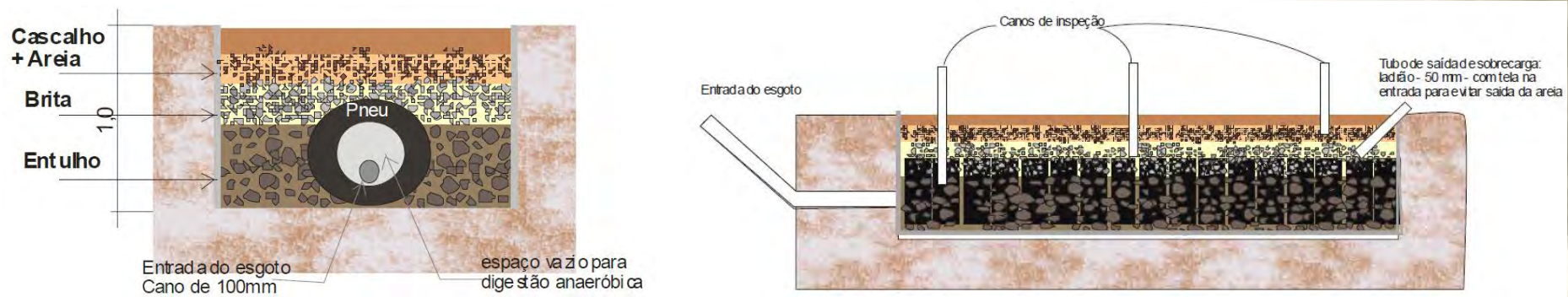
Figura 60 e 61 – Cortes transversal e longitudinal esquemáticos da bacia de evapotranspiração
